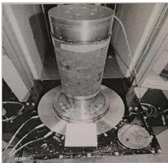
Рисунок 2.12 - Образец руды, подготовленный к испытаниям в камере объемного сжатия
