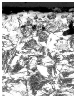
Рисунок 2 – Микроструктура никелевого покрытия при использовании \text{Na}_2\text{B}_4\text{O}_7 ( 950\text{ }^{\circ}\text{C} , 4 ч) \times 200
