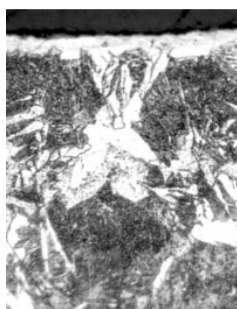
Рисунок 4 – Микроструктура никелевого покрытия при использовании \text{CaO-Li}_2\text{CO}_3\text{-B}_2\text{O}_3 (950 °C, 4 ч) \times 200
