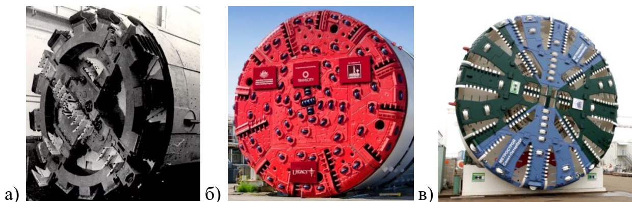
Рисунок 1.5 – Типы роторных исполнительных органов: а – ротор для мягких пород; б – ротор для скальных пород; в – гибридный ротор
