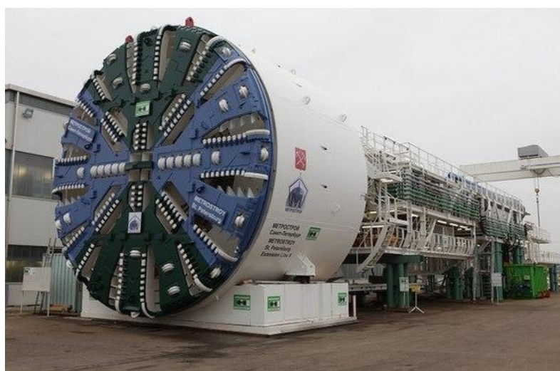
Рисунок 1.16 – Тоннелепроходческий механизированный комплекс Herrenknecht S-782
