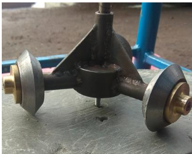
Рисунок 3.3 – Модель шарошки, установленная на образце кембрийской глины
