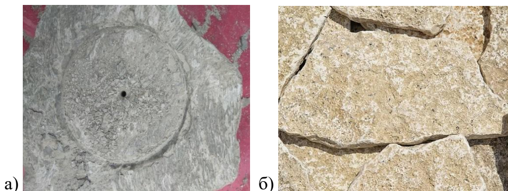
Рисунок 3.2 – Образцы: а – кембрийская глина; б – известняк
