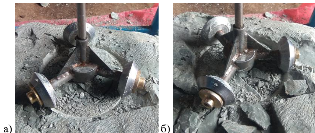
Рисунок 3.6 – Результаты эксперимента: а – P_{oc}=0,275 кН, A_{уд}=0 Дж; б – P_{oc}=0,275 кН, A_{уд}=5,4 Дж
