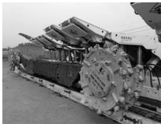
Рисунок 1.9 – Очистной комбайн MG-175/375-W
