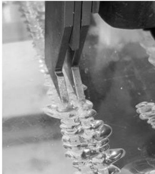
Рисунок 3.5 – Следы парных срезов органического стекла
