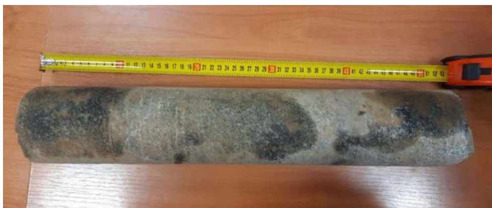
Рисунок 5.3 – Образец керна, характеризующий размеры включений валунно-галечного материала
