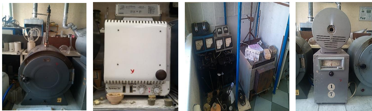
Рисунок 2.4—Нагревательные печи: А- сушильная печь ; Б- муфельная печь «Тула-3У»; В- силитовая печь (карбидо кремниевый нагреватель); Г- горизонтальная трубчатая печь
