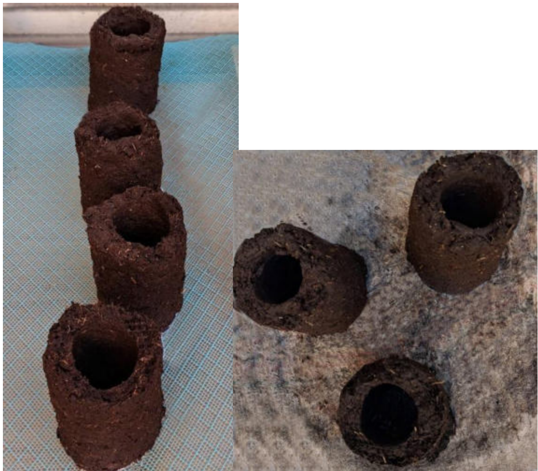
Рисунок 82 – Сушка торфяных кусков на сетке и влажной поверхности
