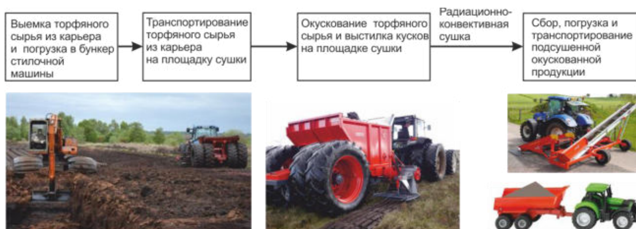
Рисунок 4 – Технологическая схема с прямой погрузкой сырья в бункер стилочной машины
