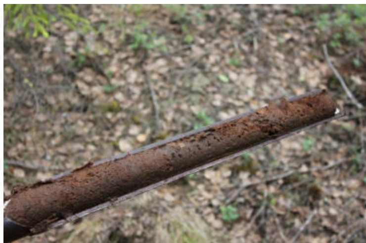
Рисунок 41 – Открытый челнок бура с торфяным сырьем
