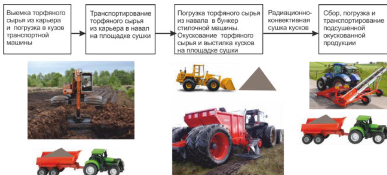
Рисунок 6 – Технологическая схема с транспортированием экскавированного торфяного сырья в навал на площадке сушки и последующим окускованием
