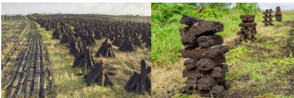
Рисунок 3 – Укладка кускового торфа в фигуры сушки для активации конвективного режима [104, 114]
