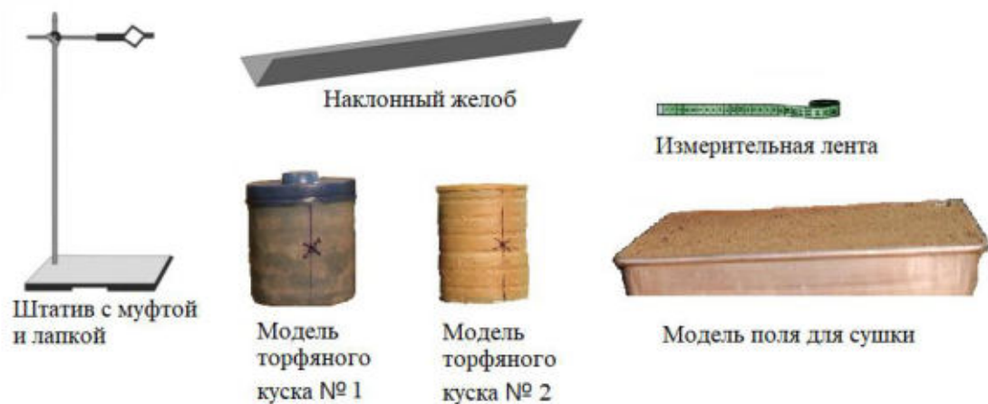
Рисунок 52 – Оборудование для лабораторного исследования по вертикальной стилки торфяных кусков
