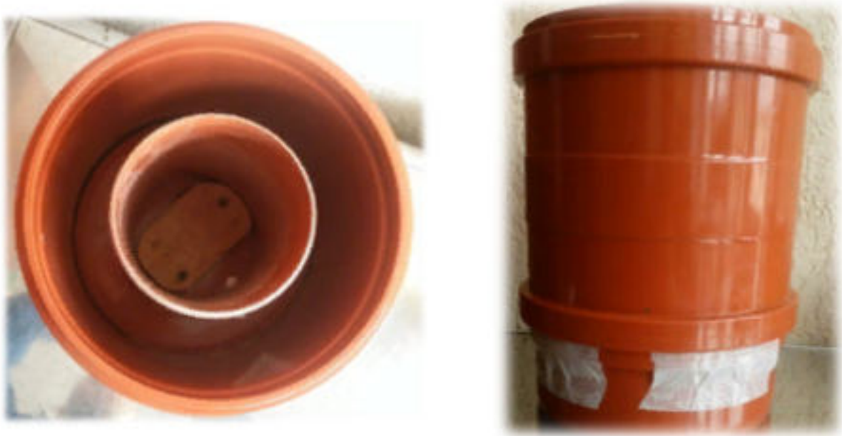
Рисунок 48 – Модель для формования торфяного сырья в трубчатую форму
