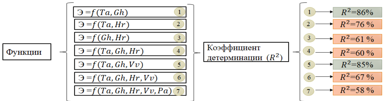
Рисунок 3.4.3 – Определение уравнений поверхности отклика и коэффициента детерминации R^2
