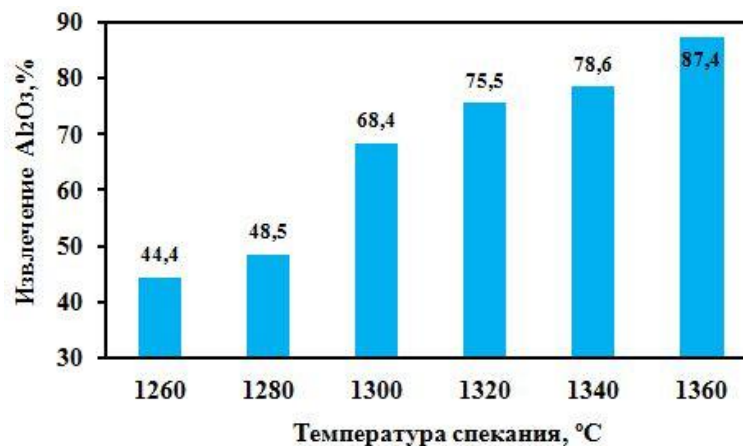
Рисунок 4.6 - Зависимость химического извлечения Al_2O_3 от температуры изотермической выдержки при спекании известняково-каолиновой шихты с добавлением 1,5 % древесного угля
