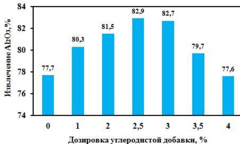
Рисунок 4.4 - Зависимость химического извлечения Al_2O_3 от количества анодного угля, добавляемого в известняково-каолиновую шихты, и его спекания при изотермической температуре выдержки 1360°C
