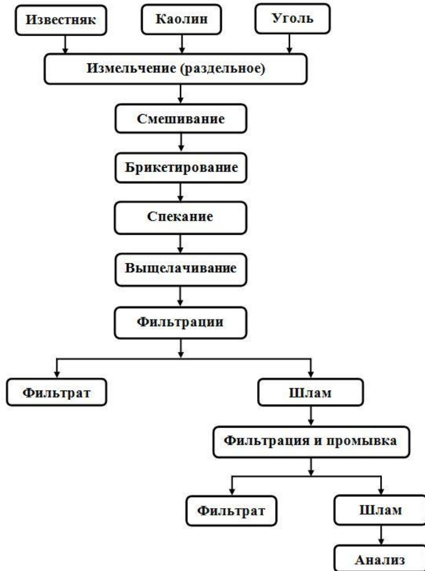
Рисунок 3.1 - Обобщённая технологическая схема исследования процесса спекания известняково-каолиновой шихты
