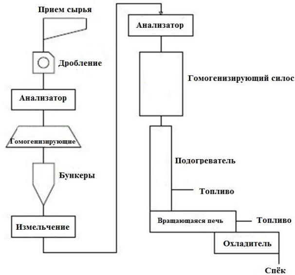
Рисунок 5.4 - Упрощенная технологическая схема для сухой технологии цементной промышленности [2]
