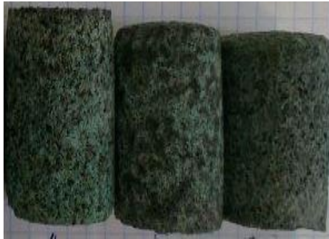
Рисунок 3.21 - Известняково-нефелиновая шихта после спекания
