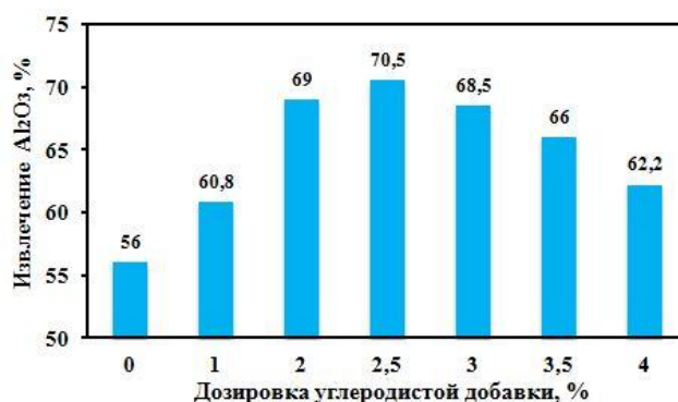
Рисунок 4.5 - Зависимость химического извлечения Al_2O_3 от количества добавки древесного угля в известняково-каолиновую смесь и его спекания при изотермической температуре выдержки 1250°C
