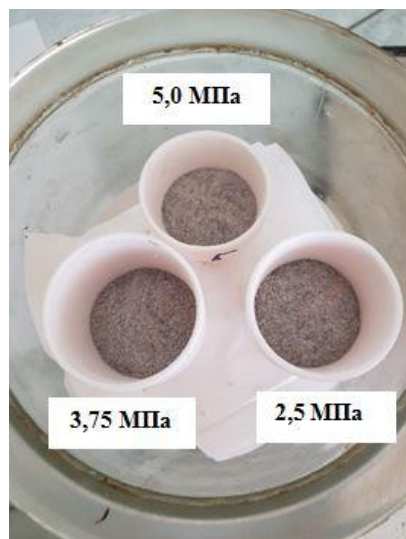
Рисунок 3.22 - Известняково-каолиновая шихта после спекания при различных давлениях брикетирования
