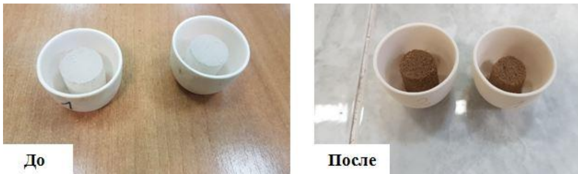
Рисунок 3.19 - Брикеты известняково-каолиновой шихты до и после спекания при температуре 1360°C с добавлением известняка менее стехиометрического количества
