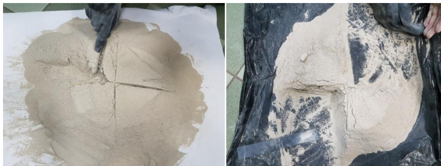
Рисунок 3.2 - Отбор пробы каолина методом квартования
