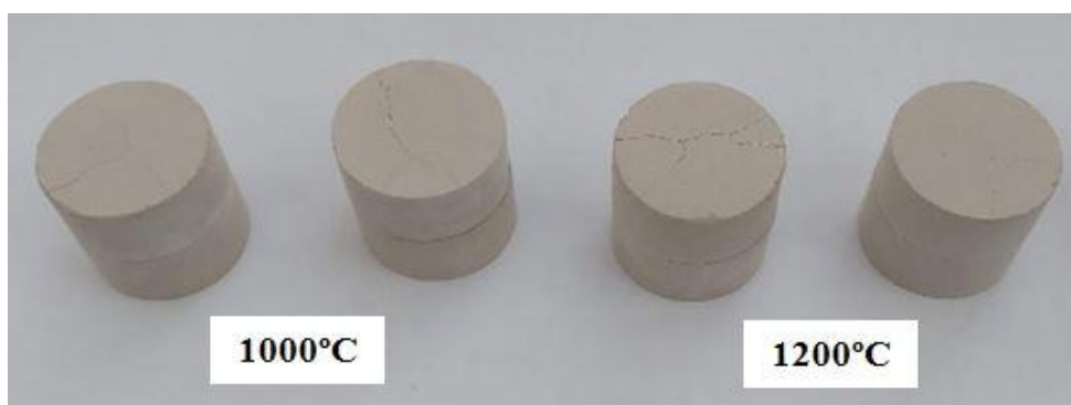
Рисунок 3.24 - Спёки, полученные при температурах 1000°C и 1200°C
