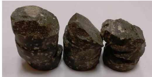
Рисунок 4.19 – Образцы известняково-каолиновой шихты после спекания с использованием каолина марки БЛКП2
