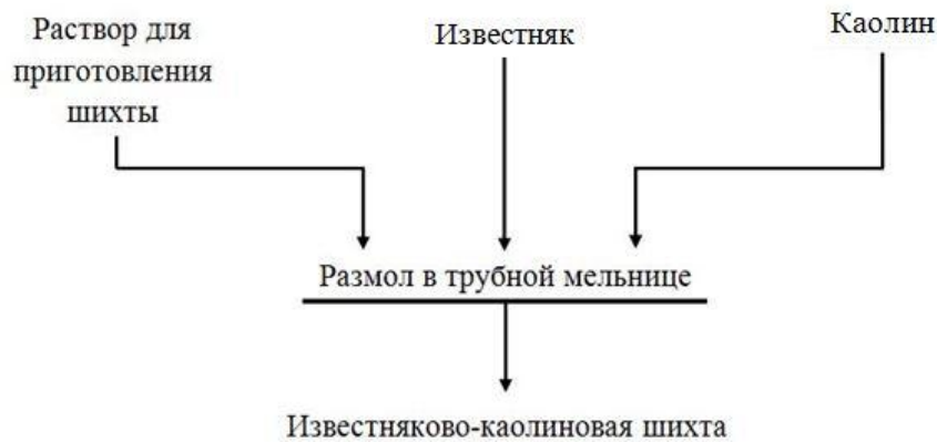
Рисунок 5.3 - Принципиальная технологическая схема приготовления известняково-каолиновой шихты, мокрый способ
