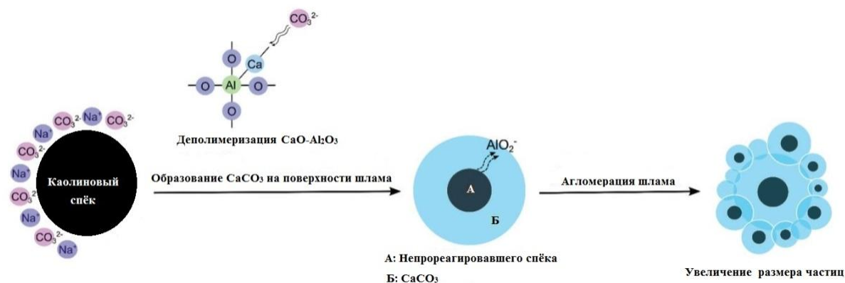
Рисунок 3.39 - Схематическое пояснение образования шламов после выщелачивания алюминатной фазы кальция с увеличением размера частиц
