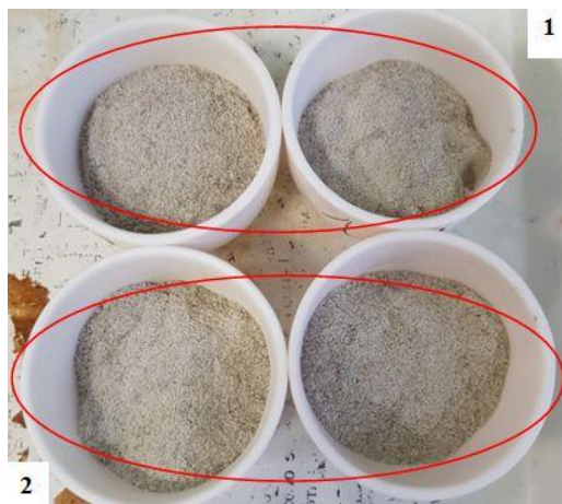
Рисунок 3.20 - Полученные саморассыпающиеся спеки при температуре 1360°C где, масс известняка 1) 234,2 г; 2) 265,8 г
