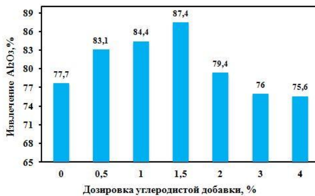
Рисунок 4.3 - Зависимость химического извлечения Al_2O_3 от количества добавки древесного угля в известняково-каолиновую шихту и его спекания при изотермической температуре выдержки 1360^{\circ}C
