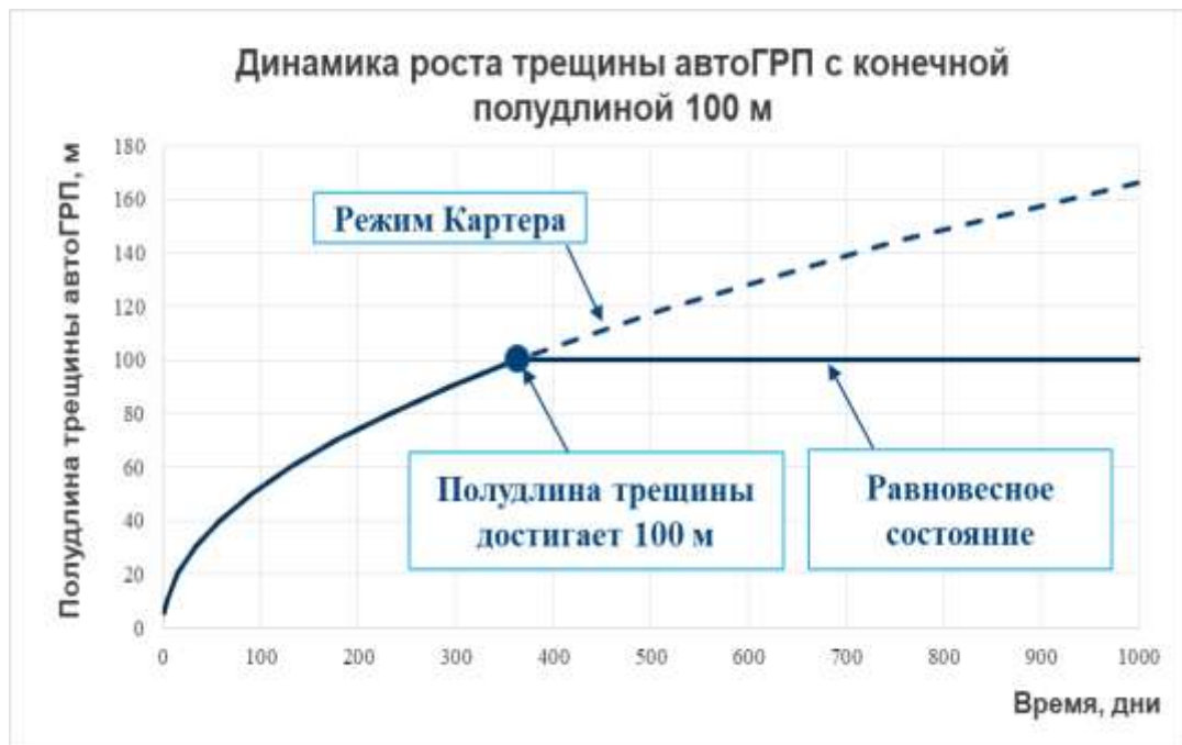
Рисунок 4.8 - Прогноз динамики роста трещины автоГРП
