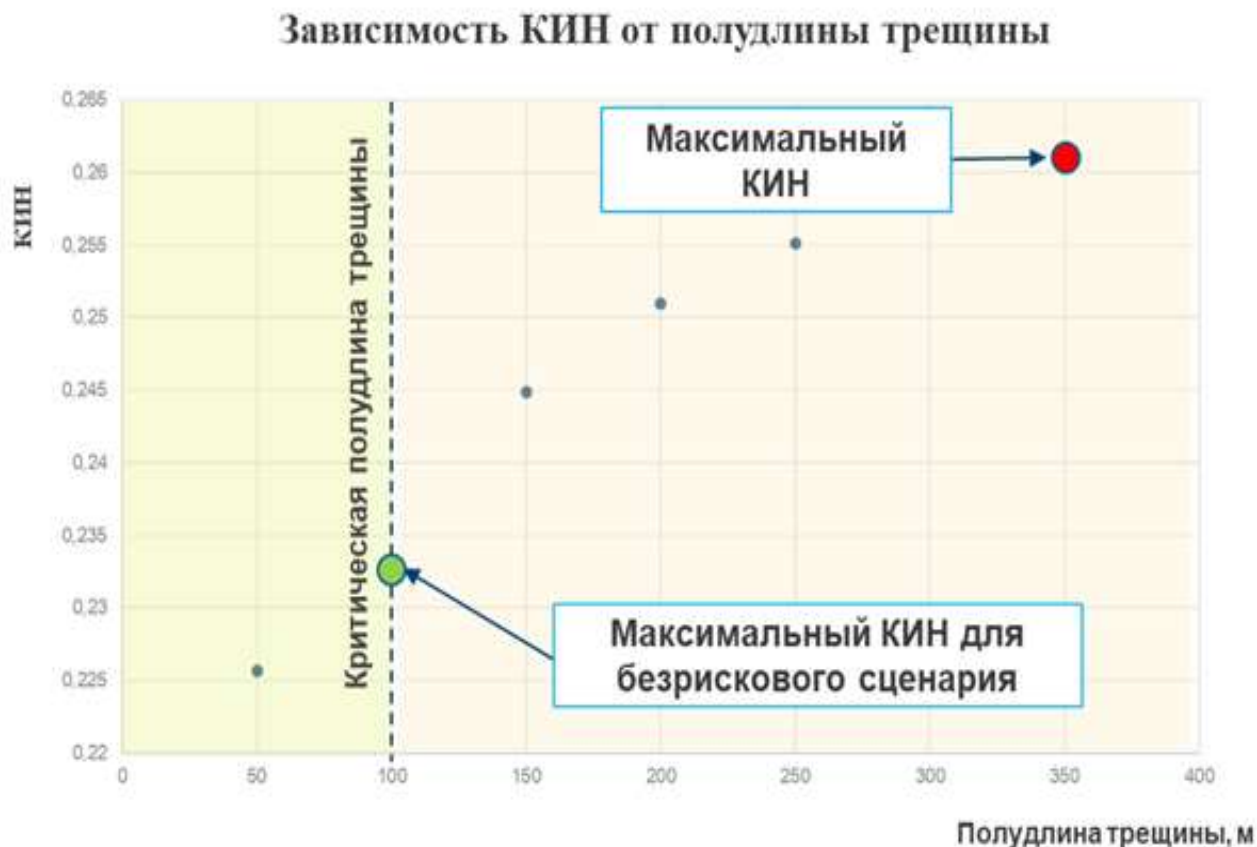
Рисунок 4.11 - Зависимость КИН от полудлины трещины автоГРП
