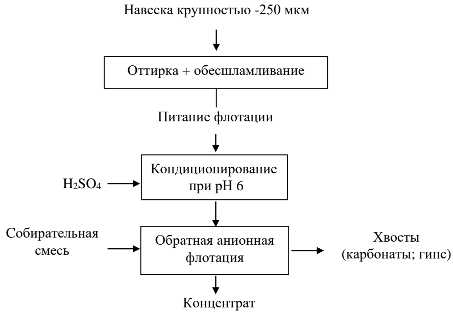
Рисунок 2.13 – Схема обратной анионной флотации
