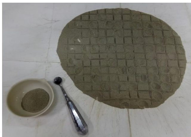
Рисунок 2.5 – Выделение представительной пробы
