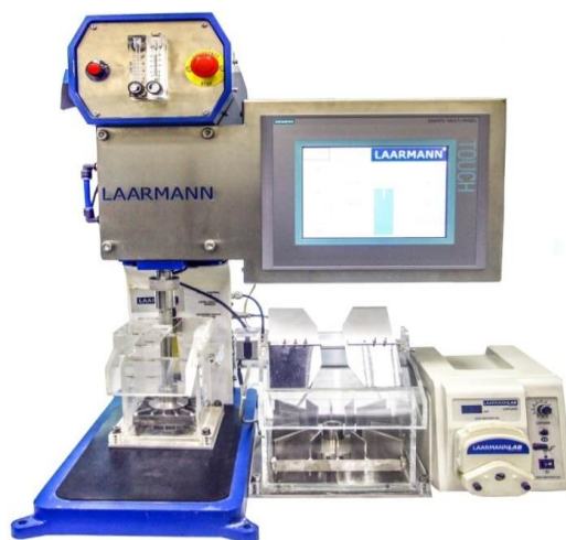
Рисунок 2.11 – Лабораторная флотационная машина фирмы Laarmann
