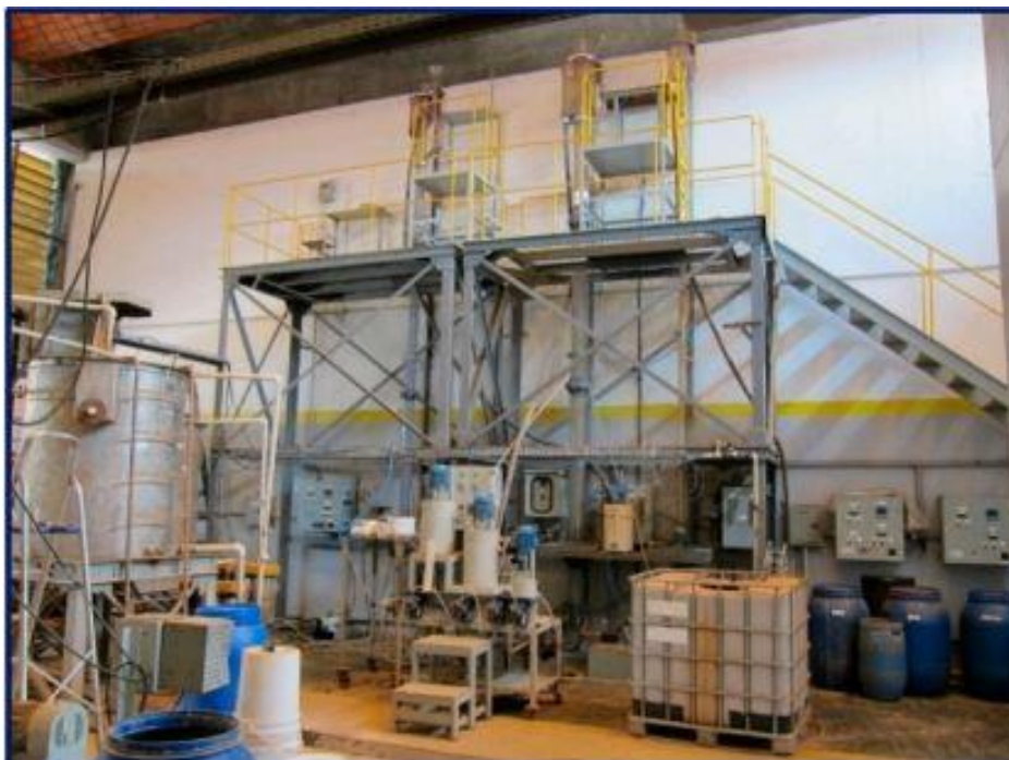
Рисунок 1.6 – Лабораторная установка колонной флотации апатитовых руд [89]
