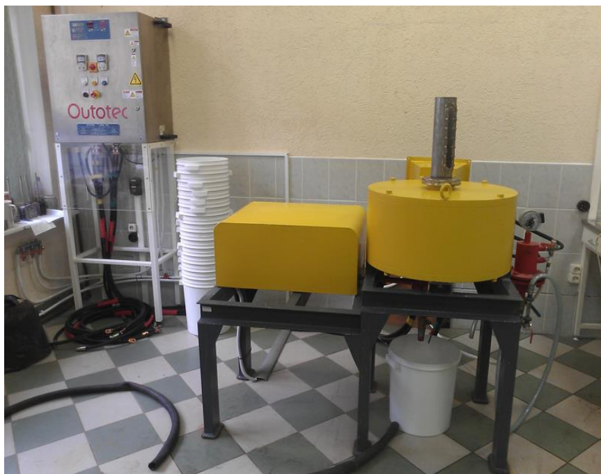
Рисунок 2.10 – Высокорадиентный магнитный сепаратор «Slon100»
