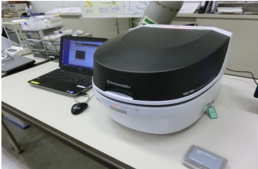
Рисунок 2.4 – Рентгенофлуоресцентный анализатор EDX 8000 компании Shimadzu
