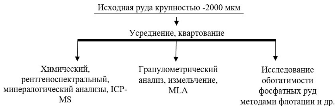
Рисунок 2.3 – Схема подготовки исходных проб к исследованию
