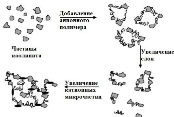
Рисунок 1.7 – Схема флокуляции каолиновой глины [106]
