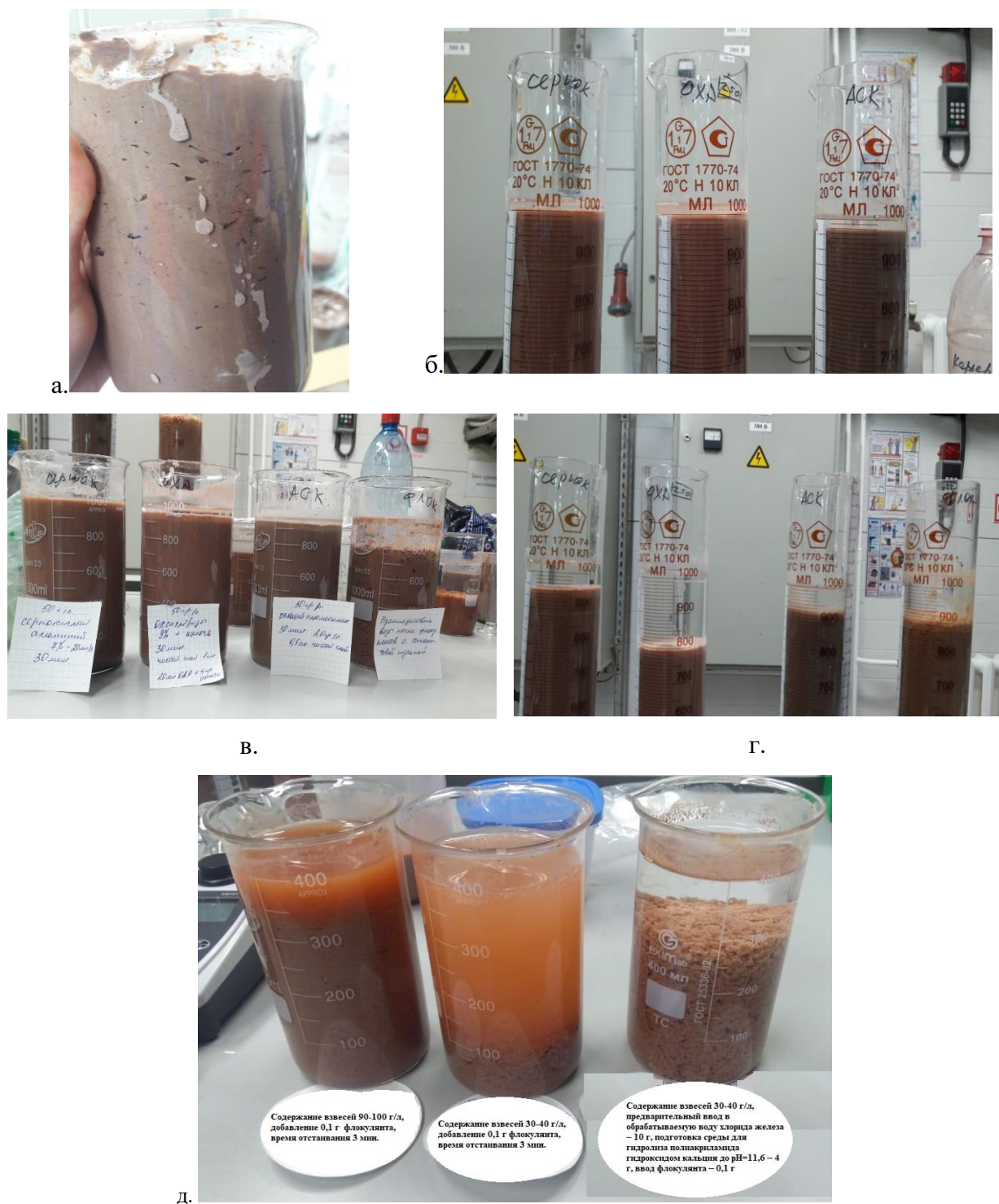
Рисунок 4.23 – Результаты опытов, проведённых на площадке Ломоносовского ГОКа: а) результат добавления 7 % раствора сернокислого алюминия в оборотную воду с содержанием твёрдого 115 г/л; б) разбавление пробы оборотной воды до 50–60 г/л, время отстаивания 60 мин; в) результаты по осаждению сапониновой пульпы с содержанием твердого 50–60 г/л спустя 30 мин, уменьшение дозировки реагентов; г) результаты по осаждению с содержанием твердого 25–30 г/л спустя 60 мин; д) опыты по предварительной обработке оборотной воды перед подачей флокулянта
