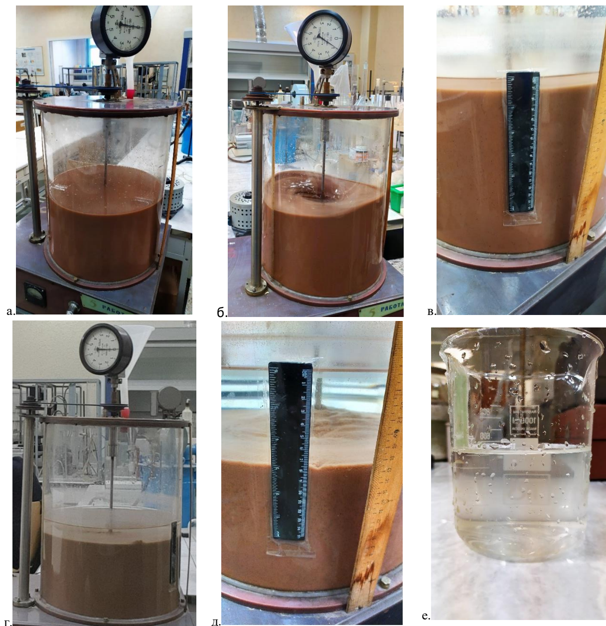
Рисунок 4.25 – Ход проведения и результаты осаждения сапониновой взвеси в оборотной воде АСК реагентом и кальцийсодержащим уплотнителем:
