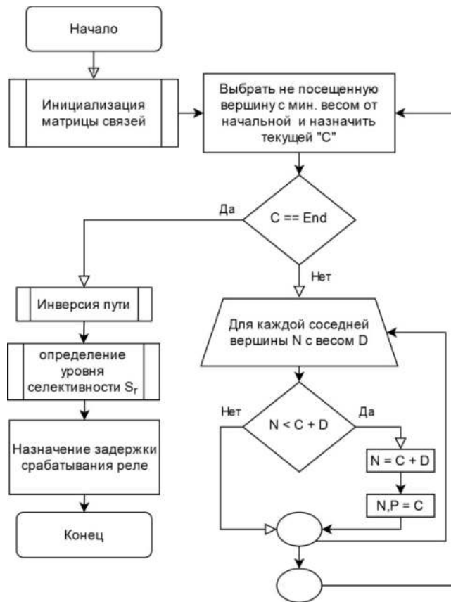
Рисунок 3.10 – Блок-схема алгоритма определения последовательности срабатывания реле в распределительной сети
