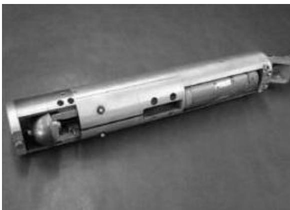
Рисунок 4.3 – Внешний вид инструмента для отбора проб стали «SSam2™ Surface Sampling Systems»
