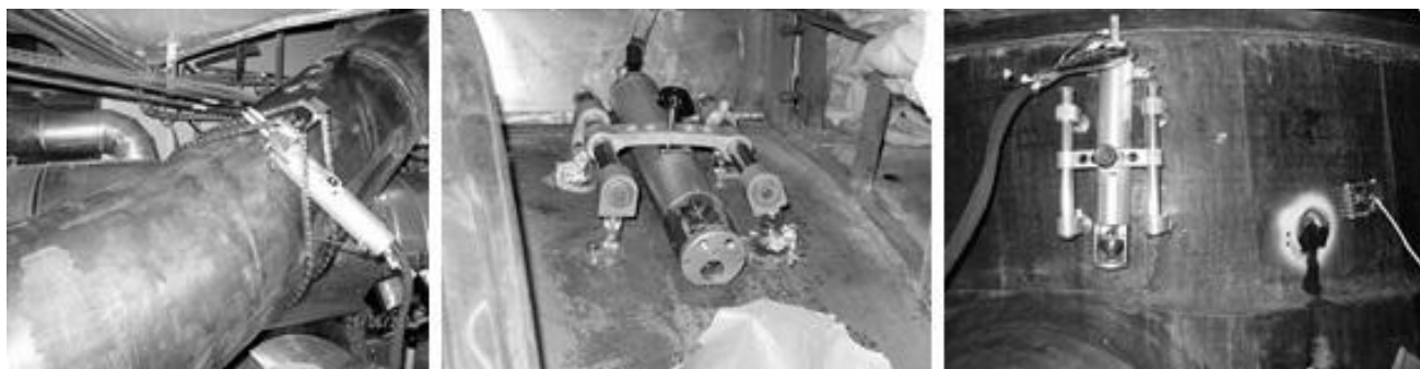
Рисунок 4.4 – Отбор проб стали при помощи аппарата «SSam2™ Surface Sampling Systems» с вырезанных катушек и футляров трубопроводов
