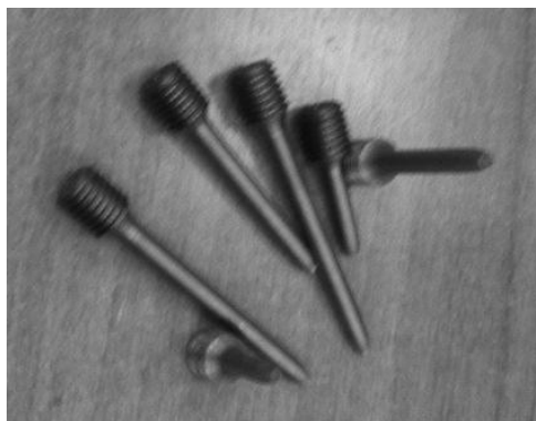
Рисунок 2.4 – Разрушенные в ходе испытаний на растяжение образцы стали СТЗ
