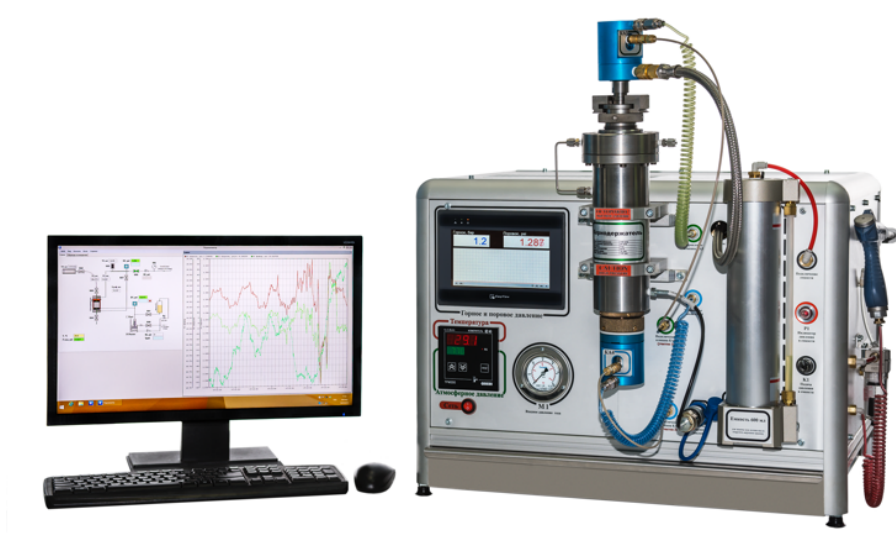
Рисунок 2.7 – Анализатор ПИК-ПП (АО «Геологика», Россия)
