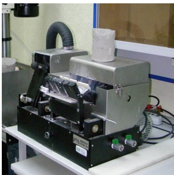
Рисунок 2.2 – Распиловочный станок DTS-430 (Coretest Systems Corporation, США)
