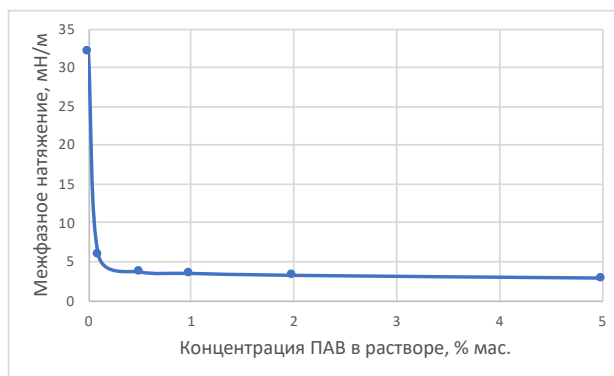
Рисунок 3.2 – Изотерма межмолекулярного взаимодействия водных растворов ОП-10 на границе с керосином марки ТС-1
