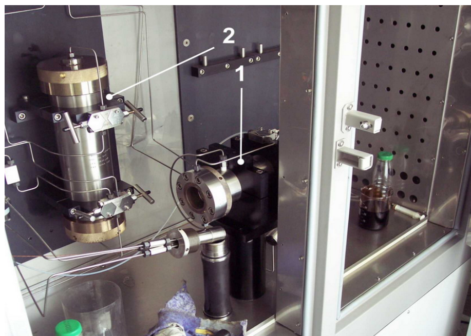
Рисунок 2.11 – Устройство фильтрационной установки RPS-812 (Coretest Systems Corporation, США),
