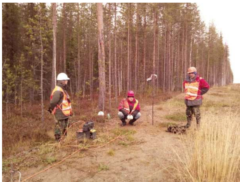
Рисунок 3.1 – Выполнение электроразведочных работ с использованием многоканальной электроразведочной станции
