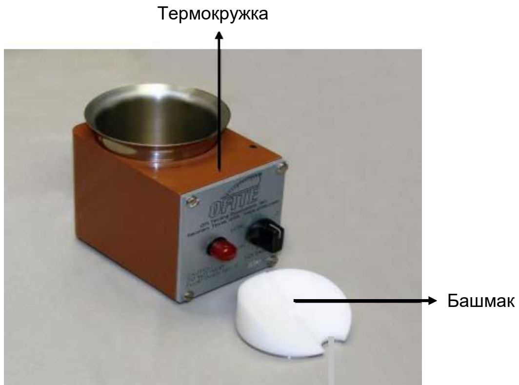
Рисунок 3.7 – Набор для определения седиментационной устойчивости
