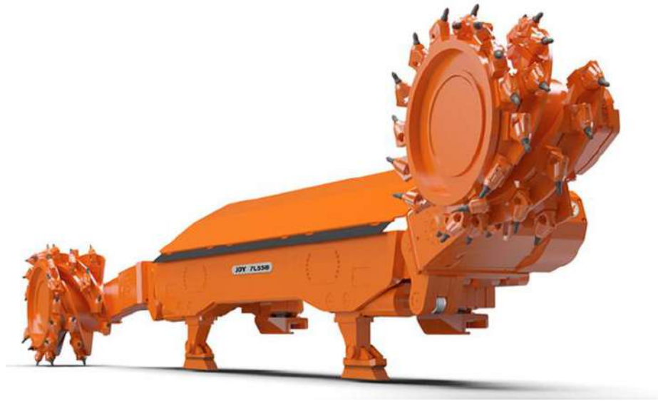
Рисунок 1.6 – Очистные узкозахватные комбайны JOI 7LS8 с расположением корпуса над конвейером
