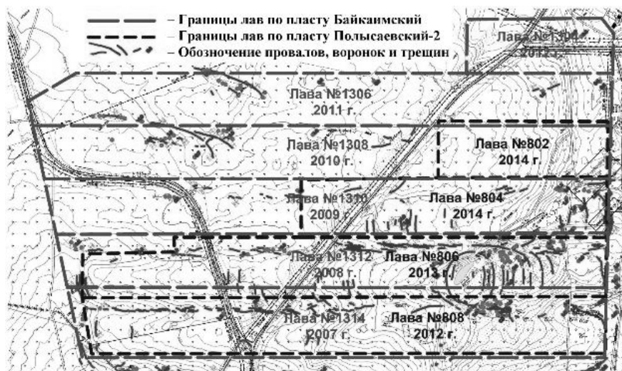
Рисунок 2 – Карта-схема мест образования провалов с указанием границ очистных выработок на участке «Красноярский»
