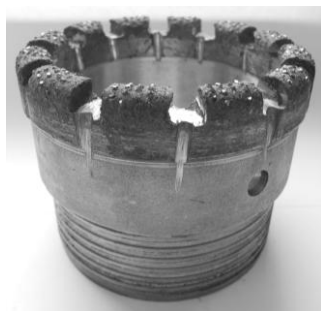
Рисунок 8 – Коронка БСО-1: а – опытный образец; б – чертеж торца коронки
