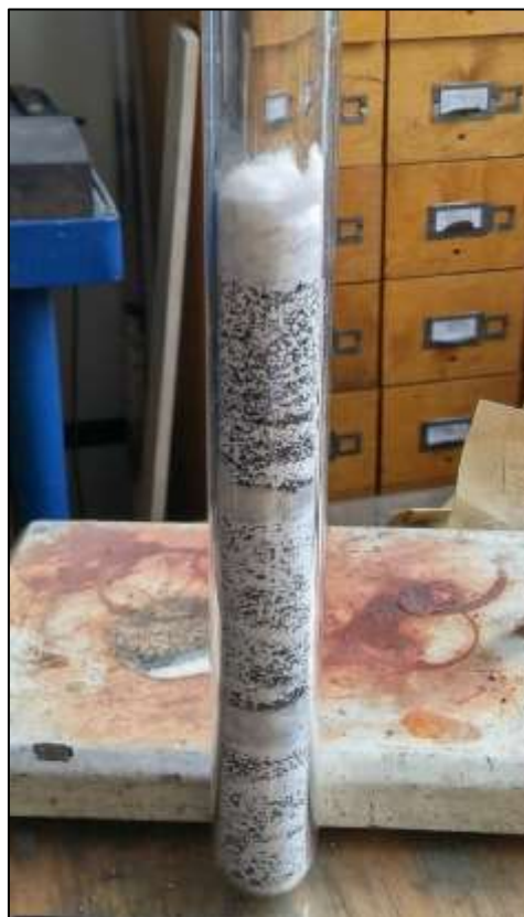
Рисунок 2.18 – Фотография кварцевого реактора с шихтой для восстановления алебастра
