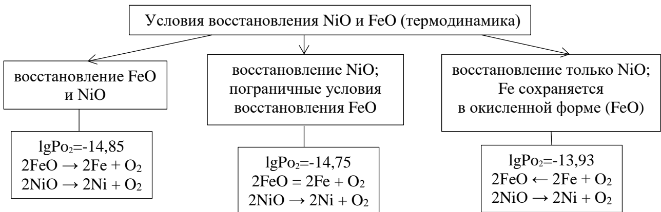
Рисунок 4.17 – Схема, иллюстрирующая термодинамику условий восстановления NiO и FeO при изменении парциального давления кислорода в газовой смеси (1000°C)
