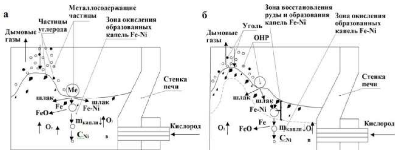
Рисунок 3.4 - Схемы переработки в ПЖВ (а) предварительно восстановленного огарка ОНР и (б) невосстановленной ОНР с получением ферроникеля
