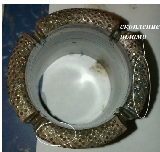
Рисунок 3.8 – Пример скопления шлама на сбегающей части сектора коронки
