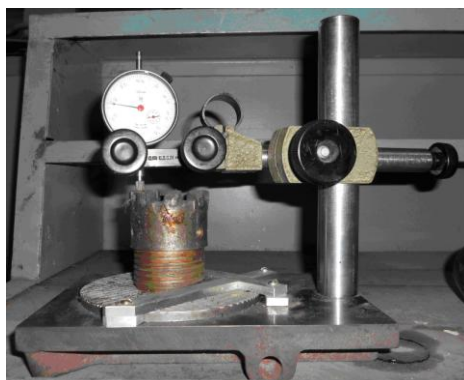
Рисунок 3.2 – Измерительная стойка с индикаторной головкой типа МИГ-1
