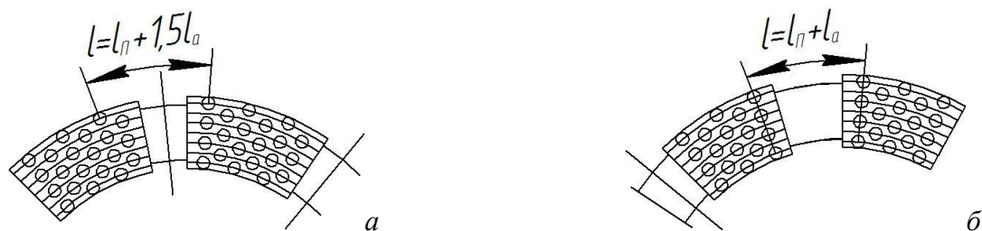
Рисунок 1.12 – Расстояние между алмазами коронок с возможными вариантами радиальных раскладок алмазов
