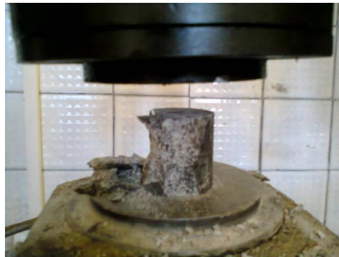
Рисунок 3.5 – Характер разрушения образца породы при одноосном сжатии
