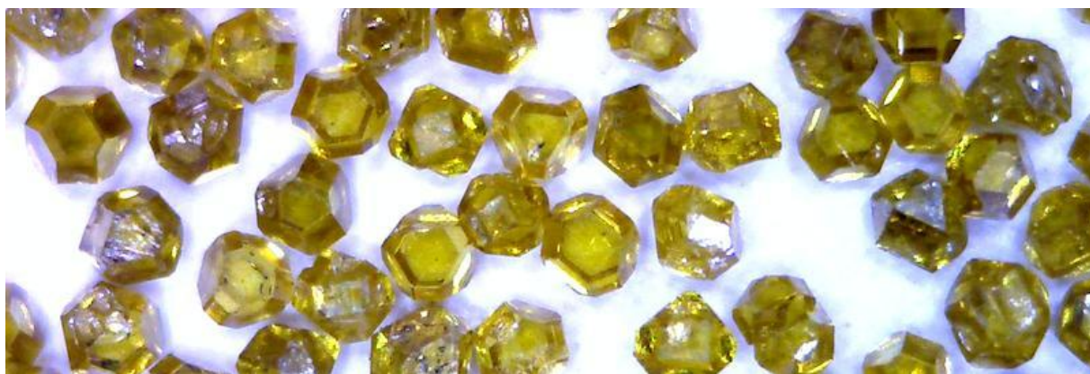
Рисунок 1.1 – Синтетические алмазные монокристаллы зернистостью 1600/1250 мкм с повышенной термостойкостью
