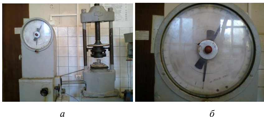
Рисунок 3.4 – Установка ПСУ-15: а – общий вид; б – датчик прибора (показание 200 кН)
