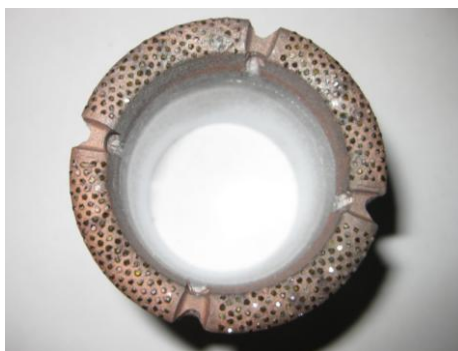
Рисунок 2.53 – Торец, серийно изготавливаемой однослойной алмазной коронки
