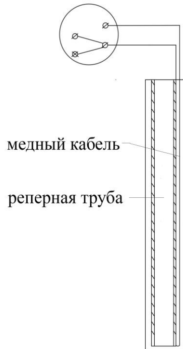
Рисунок 3.2 – Принципиальная схема размещения медного провода на реперной трубе
