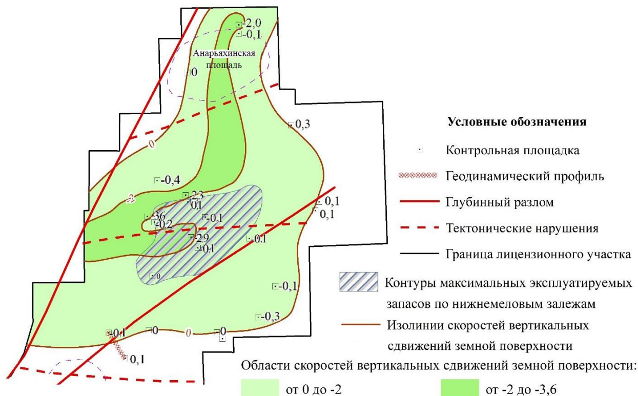
Рисунок 4.1 – Схема скоростей вертикальных сдвижений земной поверхности на Ямбургском ГДП за период 2015-2017 гг.
