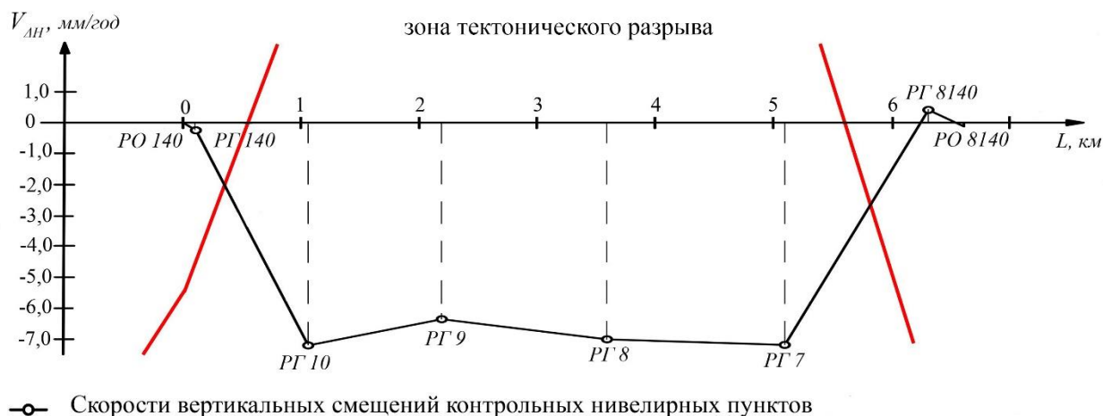
Рисунок 4.2 – График вертикальных смещений нивелирных пунктов ГП 17 за период 2015-2017 гг.
