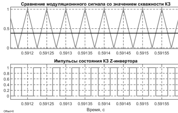
Рисунок 4.9 – Образование импульсов состояния КЗ
