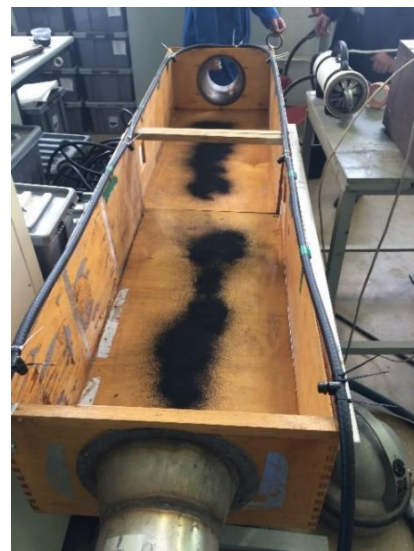
Рисунок 3.5 – Режимы подготовки станда а – без насыпи угольной пыли, б – с угольной пылью
