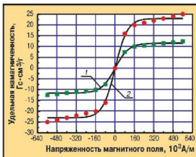
Рисунок 2.15 – Кривые намагничивания отложений на МИОН, установленном на глубине около 900 м (1) и 2000 м (2) [67]
