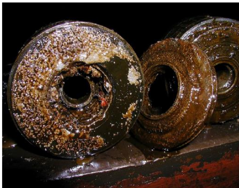
Рисунок 1.8 – Отложение солей на рабочих поверхностях ЭЦН [8]
