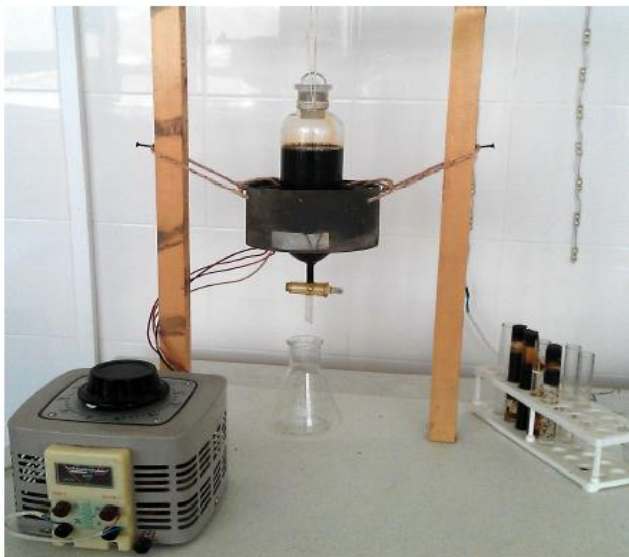
Рисунок 3.3 – Лабораторная установка демульсации водонефтяных эмульсий воздействием переменного магнитного поля [58]
