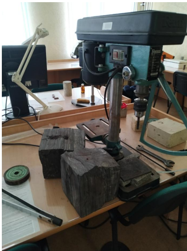
Рисунок 3.1 – Формирование зарядной полости в блоке горной породы
