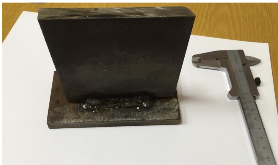
Рисунок 44 - Образец уторного узла
