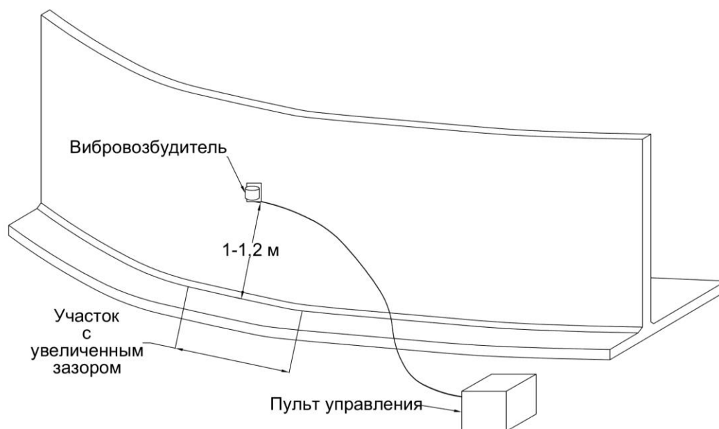
Рисунок 51 - Установка оборудования для вибрационной обработки
