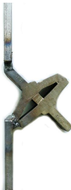
Рисунок 30 – Опытный образец уторного узла изготовленный с проведением термообработки после сварки
