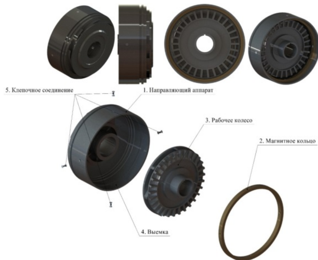
Рисунок 9 – Технические решения в конструкции электроцентробежного насоса для обработки добываемого флюида магнитным полем
