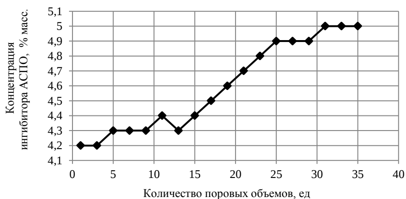
Рисунок 7 – Динамика изменения концентрации ингибитора АСПО в нефти на выходе из кернодержателя
