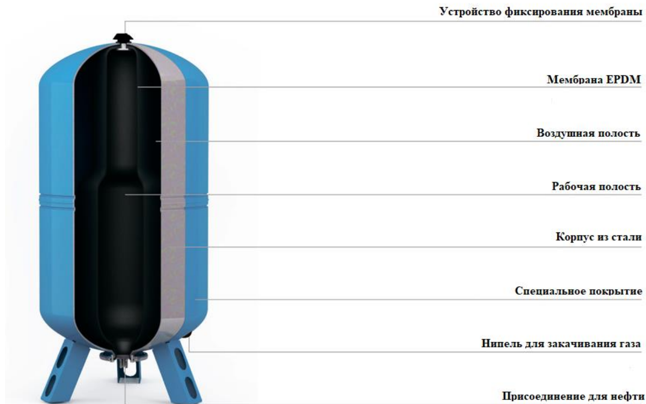
Рисунок 6 – Пример конструкции гидропневматического аккумулятора
