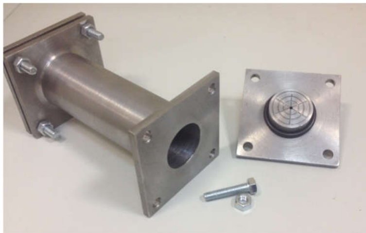
Рисунок 2.10 – Фотография разработанного кернодержателя для модели слоисто-неоднородного пласта
