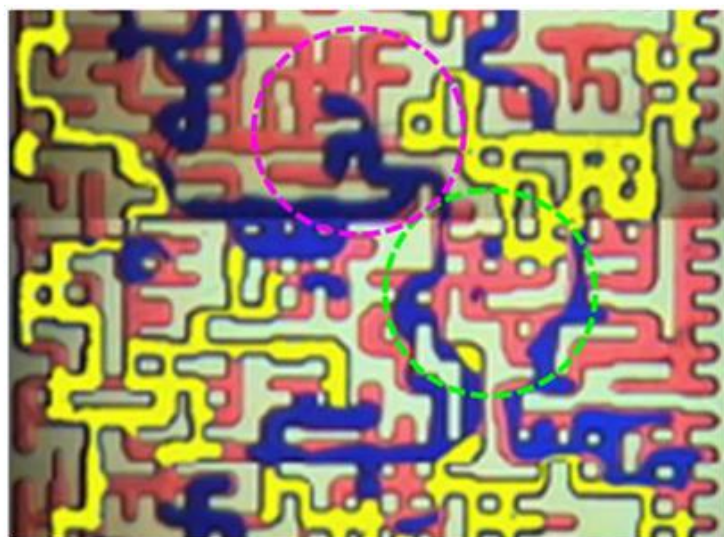
Рисунок 2 – Кадр эксперимента со стеклянной микромоделью при условии трехфазной фильтрации (красный цвет – нефть, синий цвет – вода и желтый цвет – газ)
