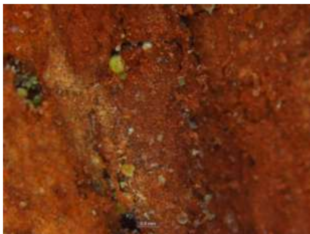
Рисунок 3.46 – Неоднородная структура поврежденной поверхности кирпича. Видны кристаллы солей
