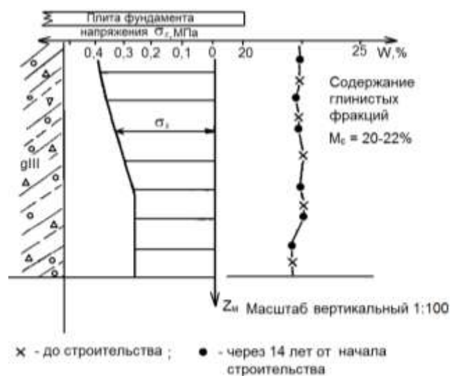
Рисунок 2.15 – Эпюры распределения нормальных напряжений \sigma_z и влажности (W) по глубине в моренных суглинках основания здания.
