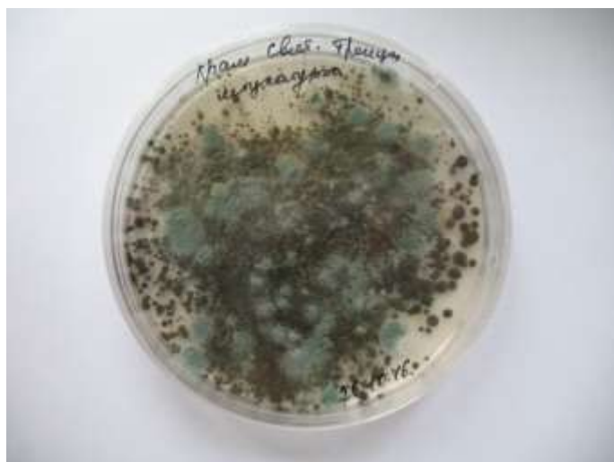
Рисунок 3.44 – Развитие колоний микромицетов из образца штукатурного покрытия с фасада храма Пресвятой Троицы
