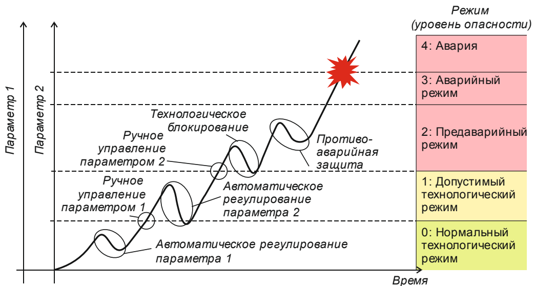
Рисунок 1.7 – Функционирование системы управления при развитии аварийной ситуации
