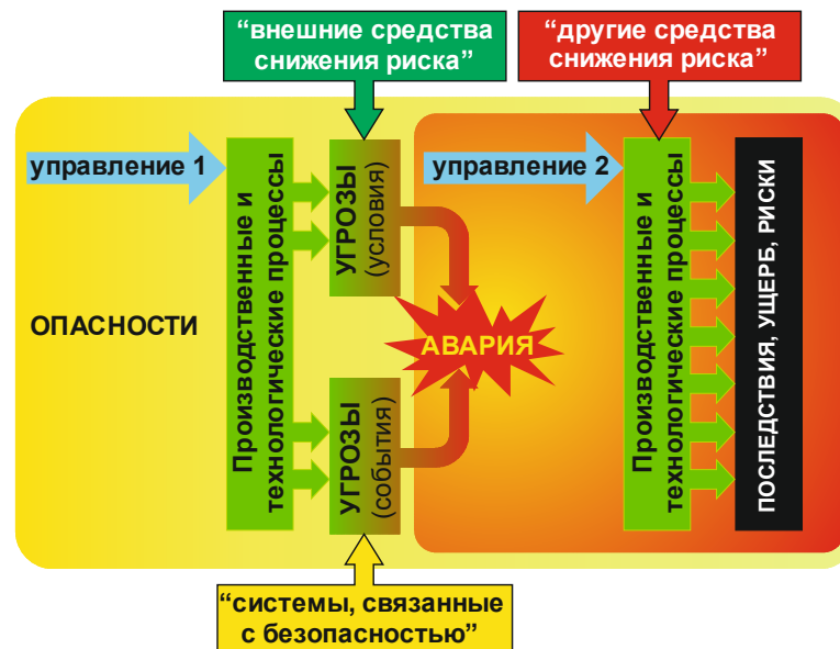
Рисунок 1.5 – Генезис опасного явления, аварии на опасном производственном объекте («внешние средства снижения рисков», «системы, связанные с безопасностью», «другие средства снижения рисков» по [94-101])
