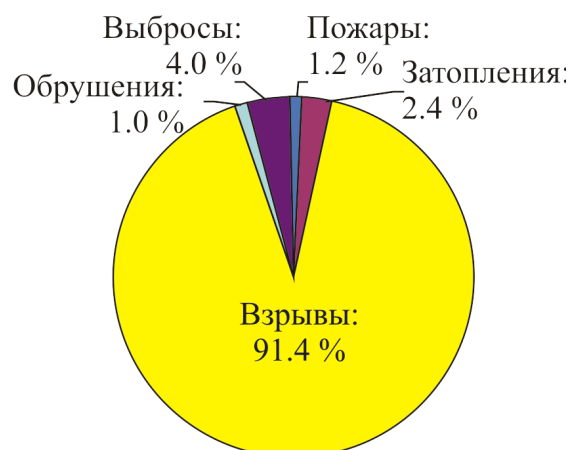
Рисунок 1.4 – Соотношения крупных аварий по видам (а) и смертельно травмированных в их результате (б) на шахтах Кузбасса за 1990-2014 г.г.
