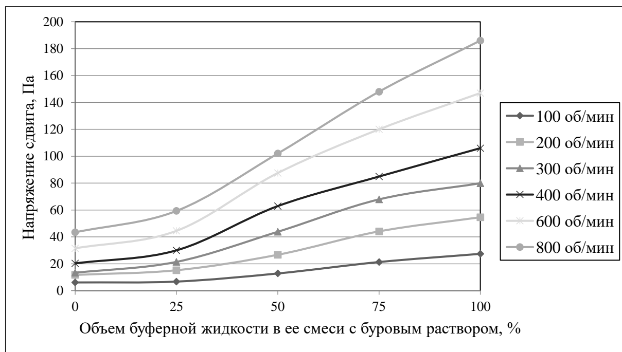
Рисунок 3.35 – Зависимость напряжения сдвига смеси буферной жидкости и бурового раствора от концентрации буферной жидкости
