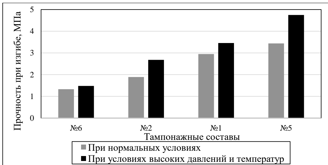
Рисунок 3.21 – Зависимость прочности при изгибе цементных образцов, содержащих гипсан от состава тампонажной смеси
