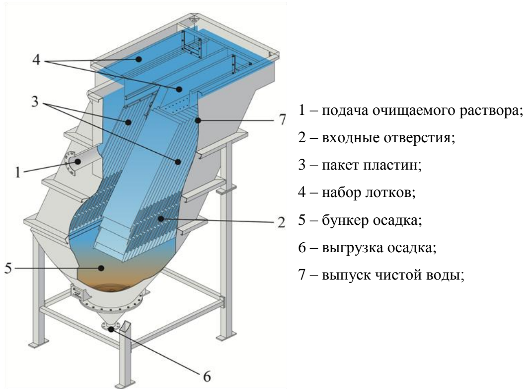
Рисунок 4.5 – Внешний вид и основные узлы сепаратора Johnson Lamella LS 120 для очистки промывной воды
