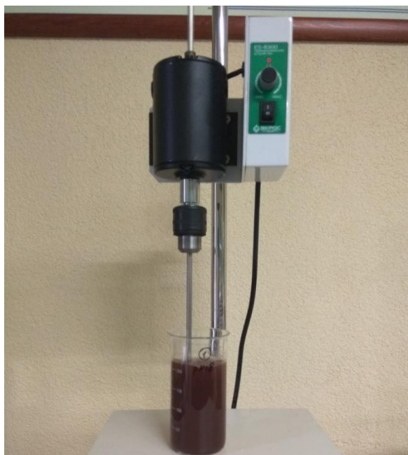
Рисунок 2.13 – Изучение десорбции компонентов из пиритных огарков при pH=8
