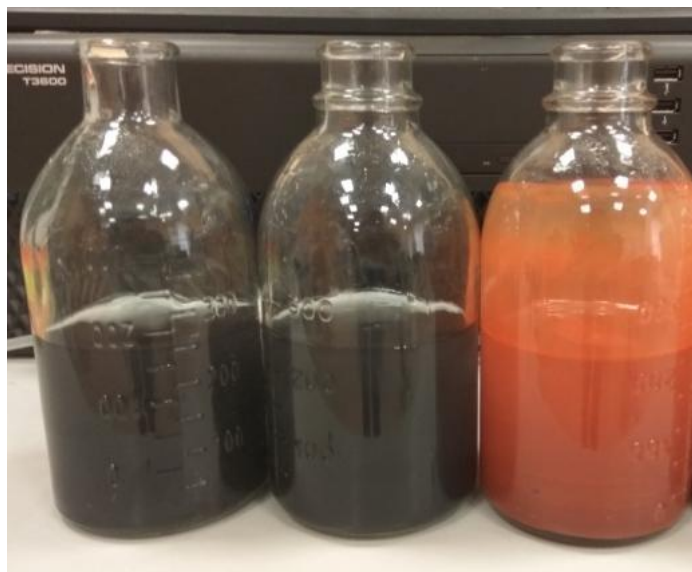
Рисунок 2.16 – Модельные растворы молибдена после очистки с использованием стандартных образцов FeO (слева), Fe 3 O 4 (в центре) и Fe 2 O 3 (справа)
