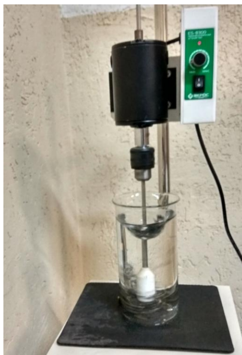
Рисунок 3.2 – Установление равновесного времени контакта образца стружки стали с удельной площадью поверхности 30 \text{ см}^2/\text{г} с модельным раствором молибдена
