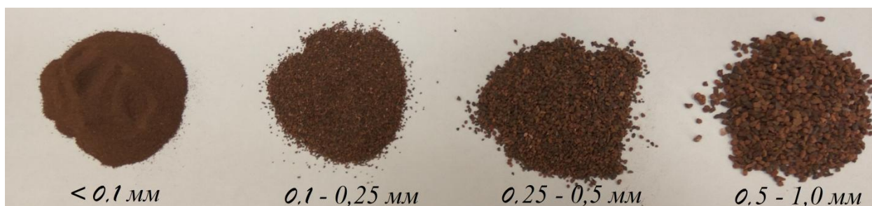
Рисунок. 2.11 – Фракции аргиллита, используемые для изучения сорбционной способности по молибдену
