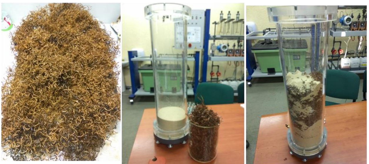
Рисунок 3.21 – Сбор хемосорбционной колонны для проведения укрупненных лабораторных испытаний по очистке модельных растворов от молибдена
