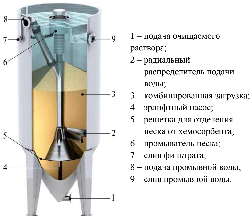
Рисунок 4.3 – Внешний вид и основные узлы фильтра DynaSand
