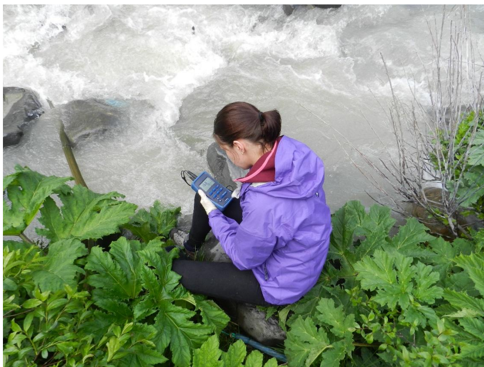
Рисунок 1.12 – Измерение нестойких показателей водных проб (pH, Eh, t)
