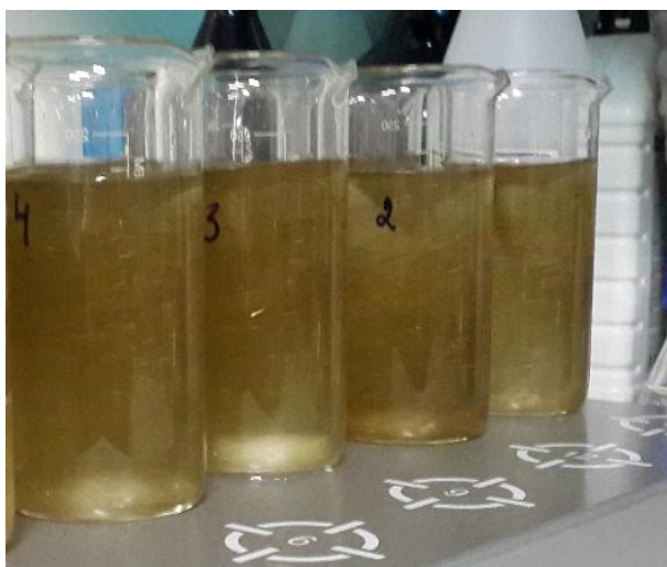
Рисунок 2.3 – Исследование сорбции молибдена на вермикулите в статических условиях
