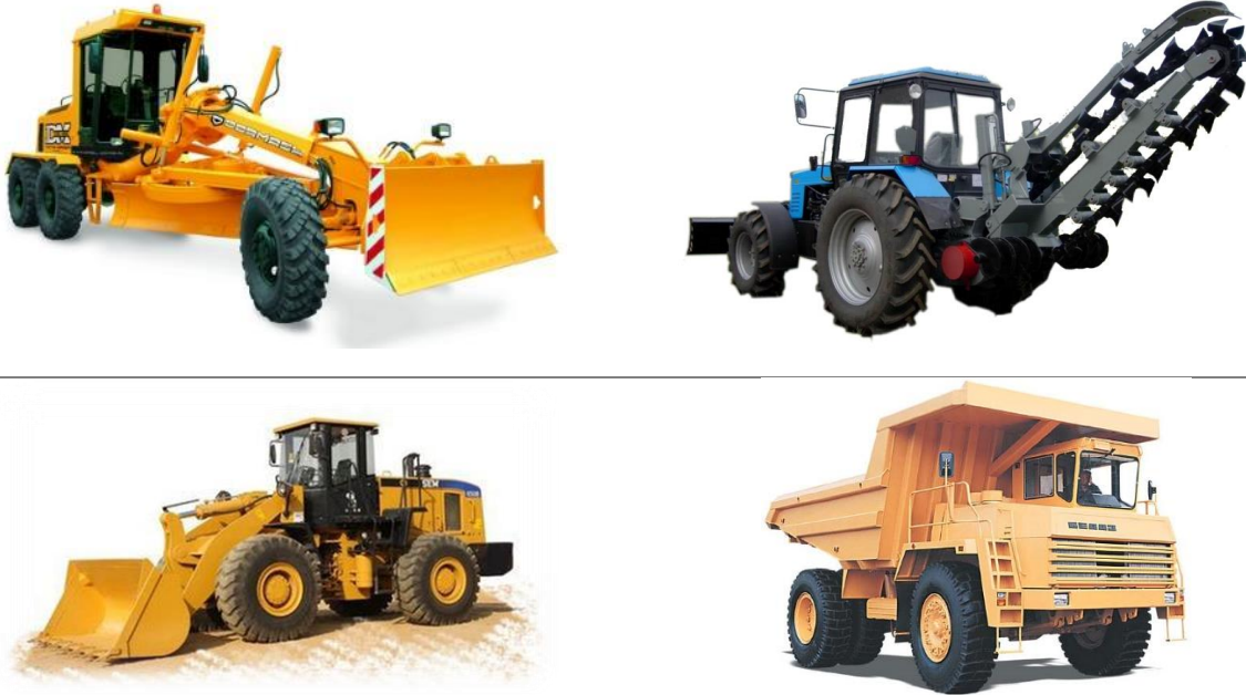
Рис. 4.3. Используемая на техническом этапе рекультивации техника. Слева сверху – грейдер ДЗ-122; справа сверху – экскаватор ЭТЦ-201; слева внизу – погрузчик фронтальный SEM 650В; справа внизу – самосвал БелАЗ-7523 (источники: www.spectehnika-info.ru , www.rosspecteh.ru ).
