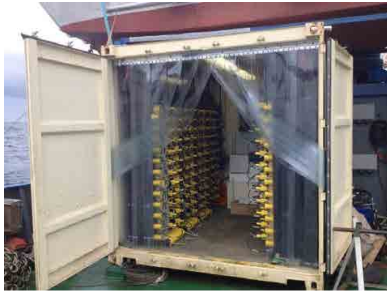
Рисунок 2.11. Размещение донных регистраторов OBX на борту судна.
