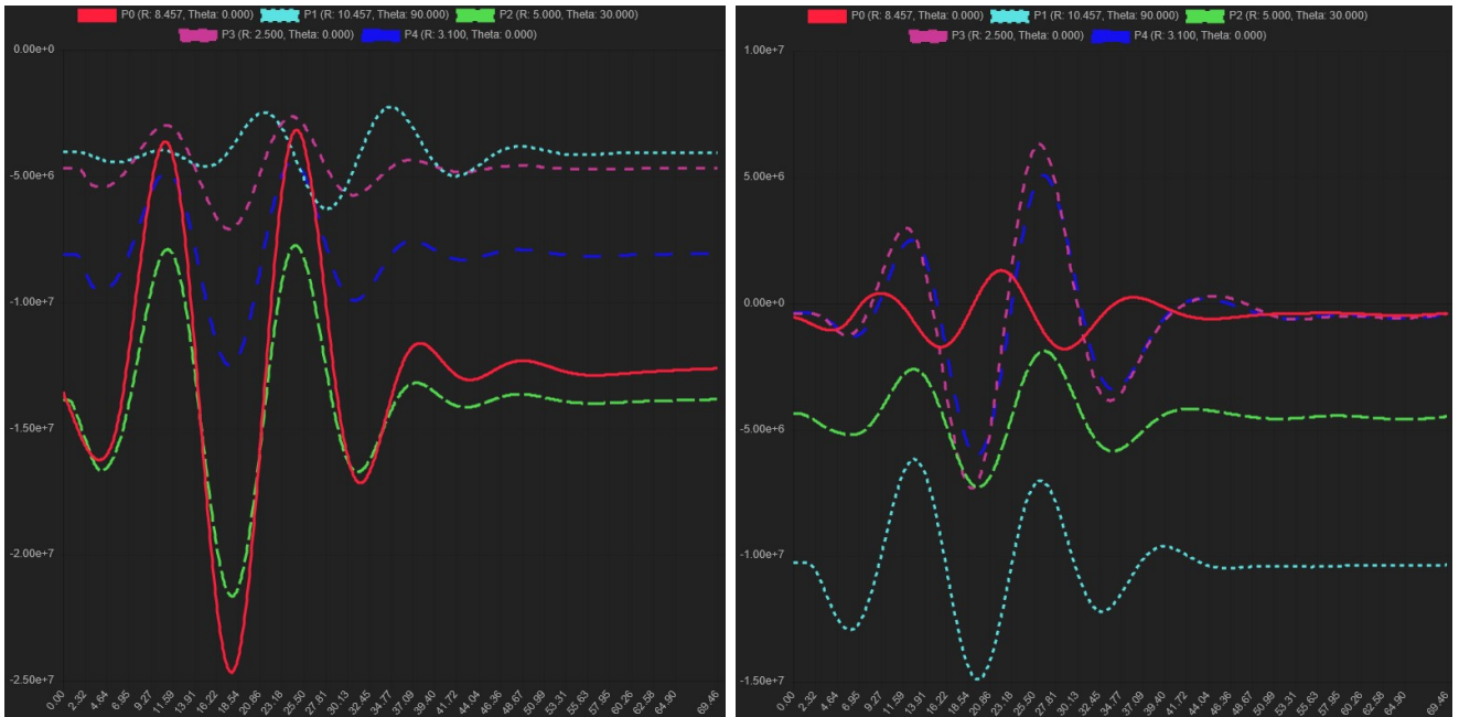
Рисунок 3.48 – Компоненты тензора напряжений \sigma_{11} и \sigma_{22} (горизонтальная ось, время, мс; вертикальная ось, напряжение, Па)
