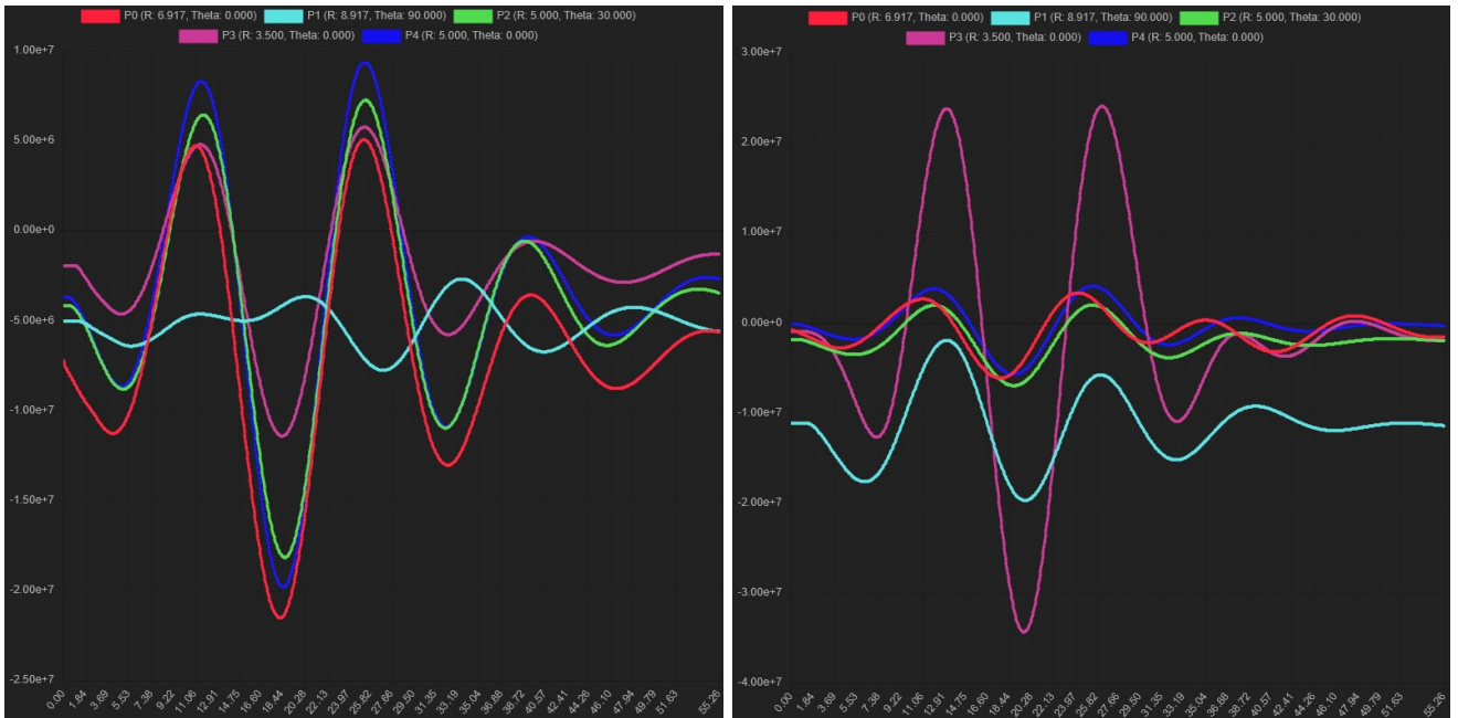
Рисунок 3.36 – Компоненты тензора напряжений \sigma_{11} и \sigma_{22} (горизонтальная ось, время, мс; вертикальная ось, напряжение, Па)
