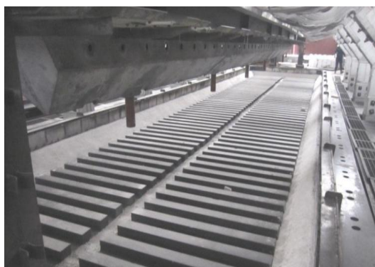
Рисунок 1.9 – Рельефная подина технологии «Novel structure of cathode» (NSC) компании «Chalco»
