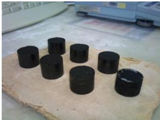
Рисунок 2.2 - Прессованные образцы ХНПМ
