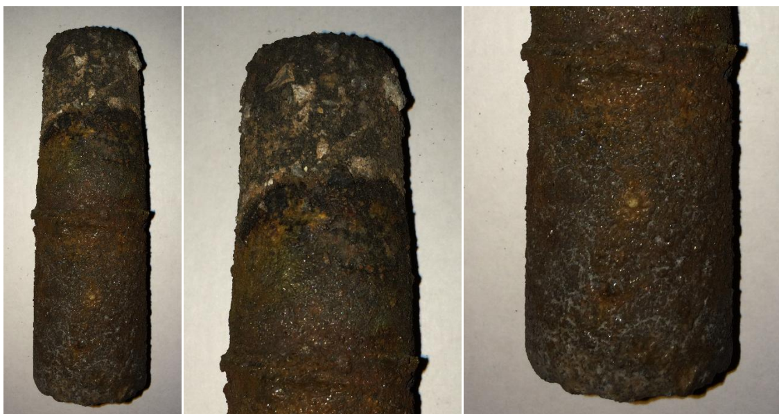
Рисунок 3.11 – Внешний вид образца УГМ после выдержки в электролите \text{LiF}
