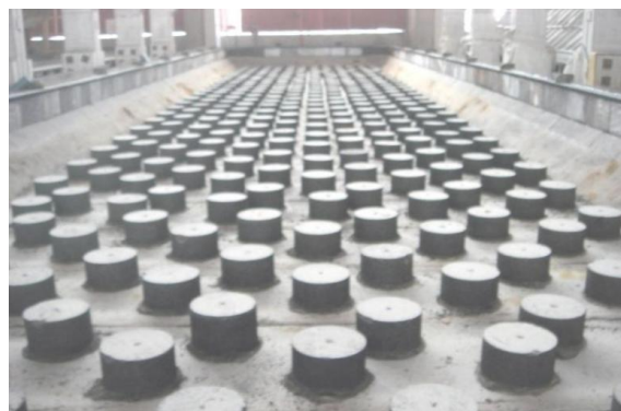
Рисунок 1.9 – Рельефная подина технологии «Novel structure of cathode» (NSC) компании «Chalco»
