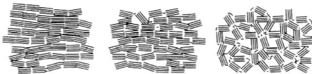
Рисунок 1.8 - Упрощенные модели ориентации кристаллитов с различной степенью графитизации в продольном разрезе: а – графитизированный; б – частично графитизированный; в – неграфитизированный [3, 43]. При большем масштабе разрешения, каждый кристаллит может также, представлен в виде зерна в углероде, которое имеет свою определенную анизотропию текстуры и пространственную ориентацию
