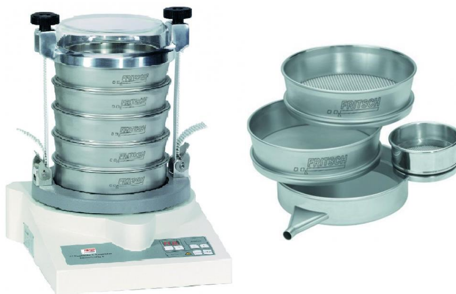
Рисунок 1.3 – Вибрационный грохот с ситовой колонной (слева) и набор сит (справа) (Fritsch, Германия)
