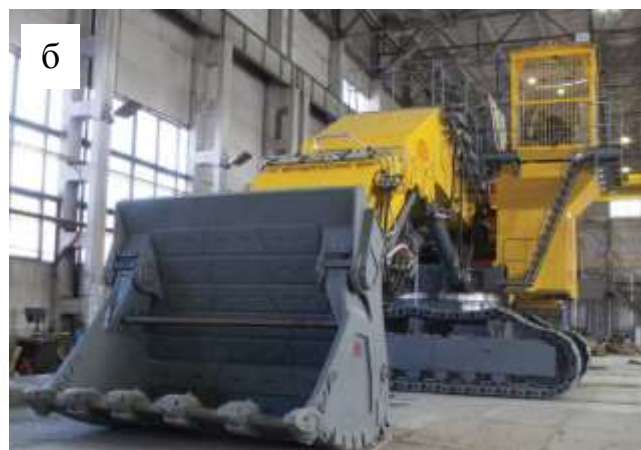
Рисунок 1.9 – Проект российского гидравлического экскаватора УГЭ-300
