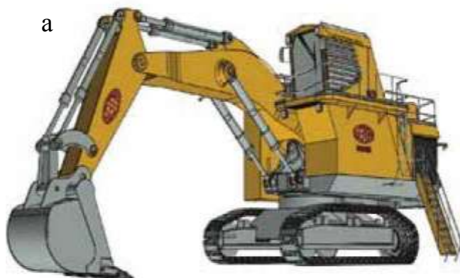
Рисунок 1.9 – Проект российского гидравлического экскаватора УГЭ-300
