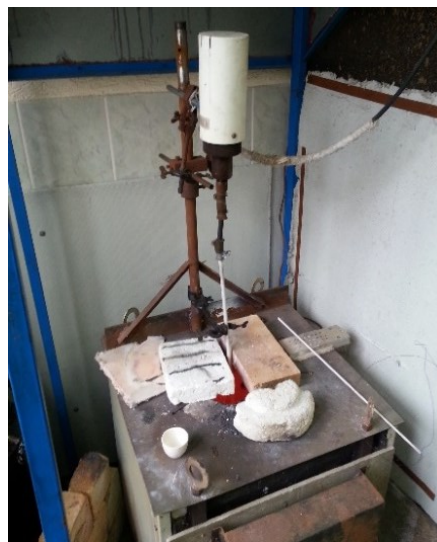
Рисунок 3.1 – Схема (а) и фотография (б) лабораторной установки для проведения исследований: 1 – шахтная электропечь; 2 – нагревательные элементы; 3 – термопара ХА; 4 – терморегулятор; 5 – графитовый тигель; 6 – расплав алюминия; 7 – хлоридно-фторидный расплав; 8 – перемешивающее устройство (ПУ); 9 – пульт управления ПУ
