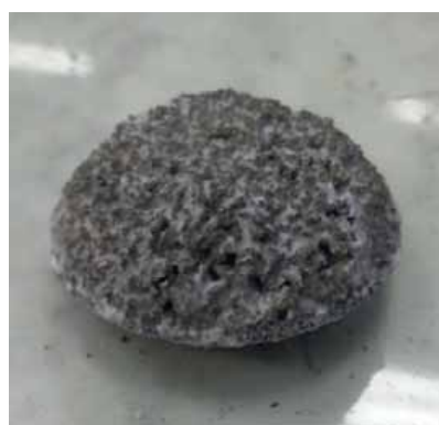
Рисунок 3.33 – Продукт синтеза лигатуры в расчете на получение ИМС Al_3Er : а) только вытасченный из печи, б) закристаллизованный
