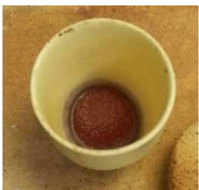
Рисунок 3.33 – Продукт синтеза лигатуры в расчете на получение ИМС Al_3Er : а) только вытасченный из печи, б) закристаллизованный
