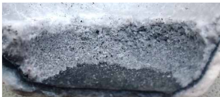
Рисунок 3.18 – Изображение дна тигля после получения лигатуры, на котором видны не солевые частицы
