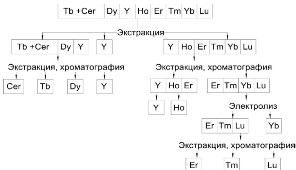
Рисунок 1.1 – Принципиальная схема разделения РЗЭ иттриевой подгруппы [24]
