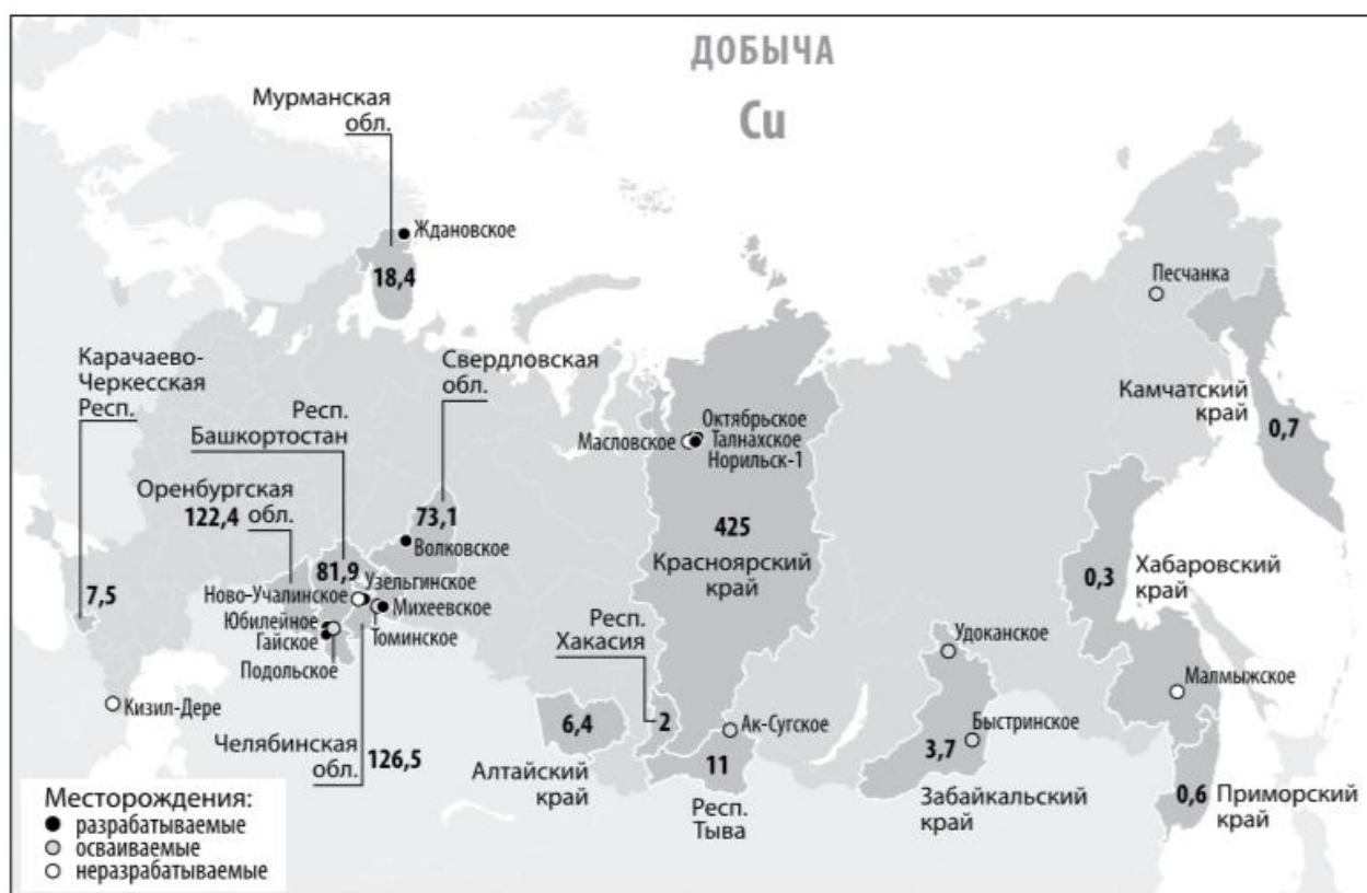
Рисунок 1.7 - Основные месторождения меди и распределение ее добычи (включая добычу из руд техногенных месторождений) по субъектам Российской Федерации, тыс. т.
