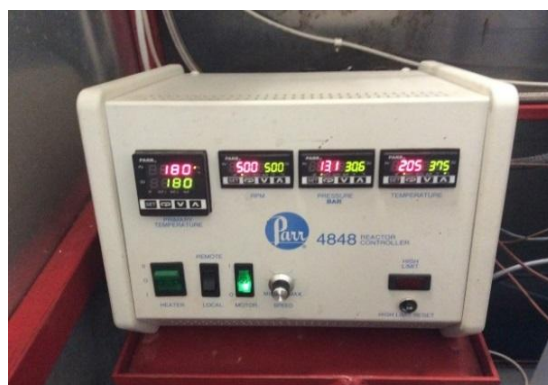
Рисунок 2.6 - Блок управления автоклавом с системой автоматического контроля и регулирования температуры и давления
