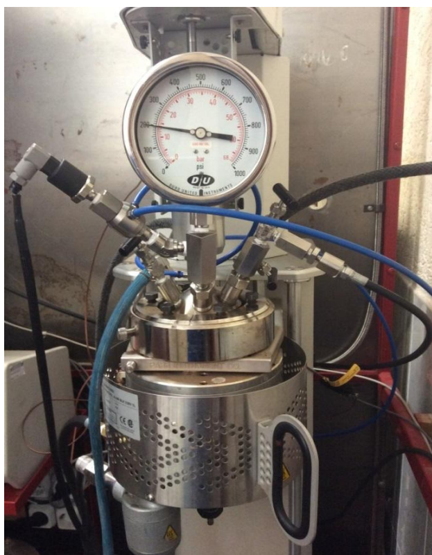
Рисунок 2.5 - Титановый автоклав Parf с двухъярусной лопастной мешалкой с регулируемым числом оборотов, объем 1 л
