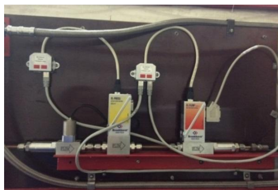
Рисунок 2.7 - Система контроля и измерения расхода газообразных реагентов
