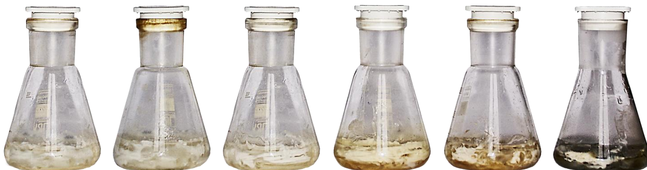
Рисунок 2.15 – Образцы цементирующего вещества, полученные при взаимодействии вяжущей и отверждающей жидкостей (№№1-6 слева-направо)
