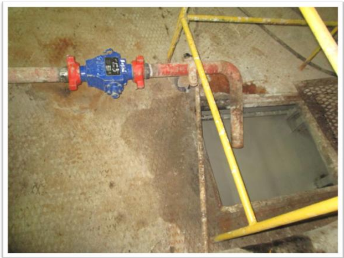
Рисунок 2.4 – Применение на буровой диспергатора ДГС 40-20
