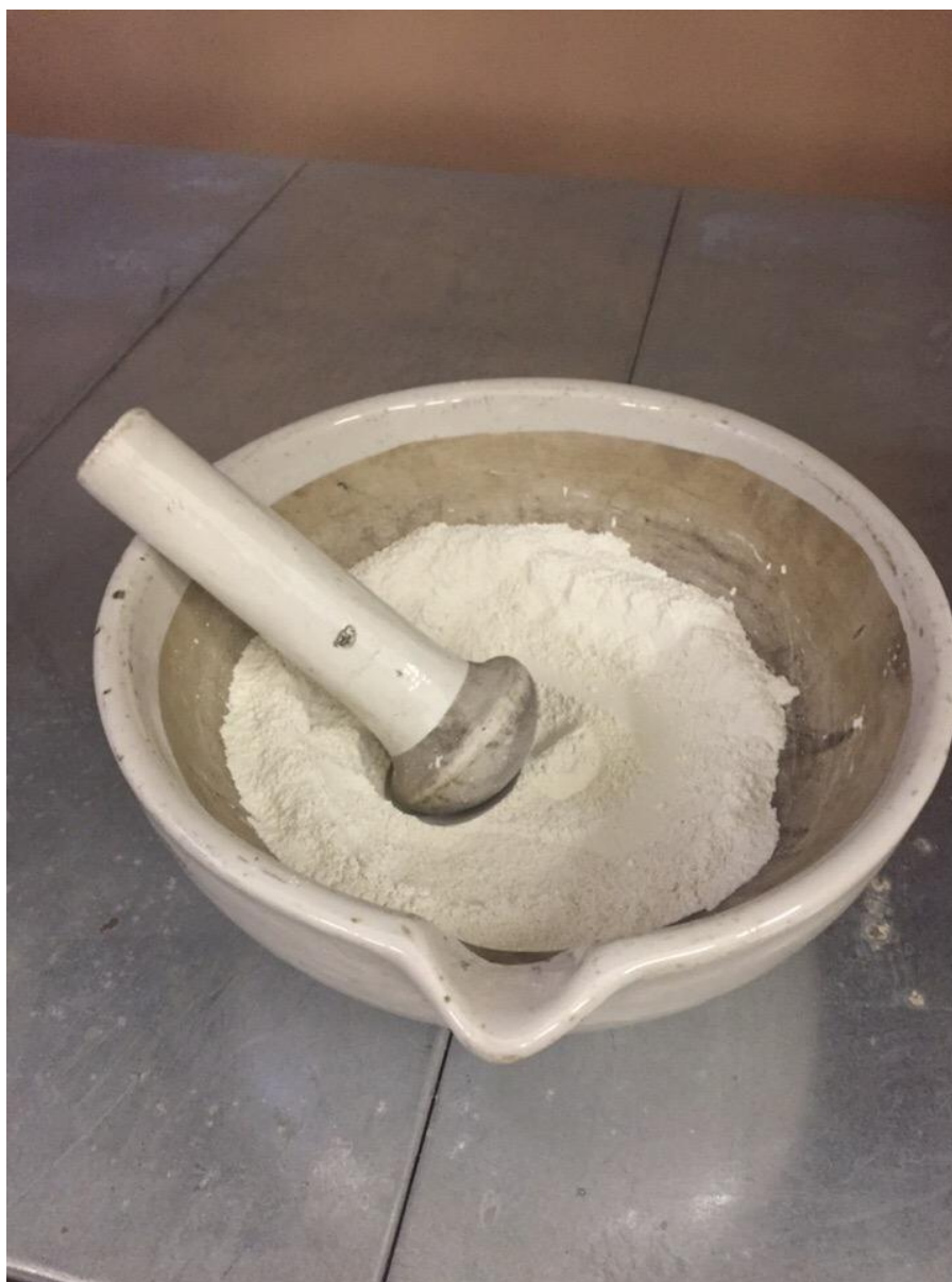
Рисунок 3.5 - Измельченный карбонат кальция \text{CaCO}_3 перед проведением ситового анализа
