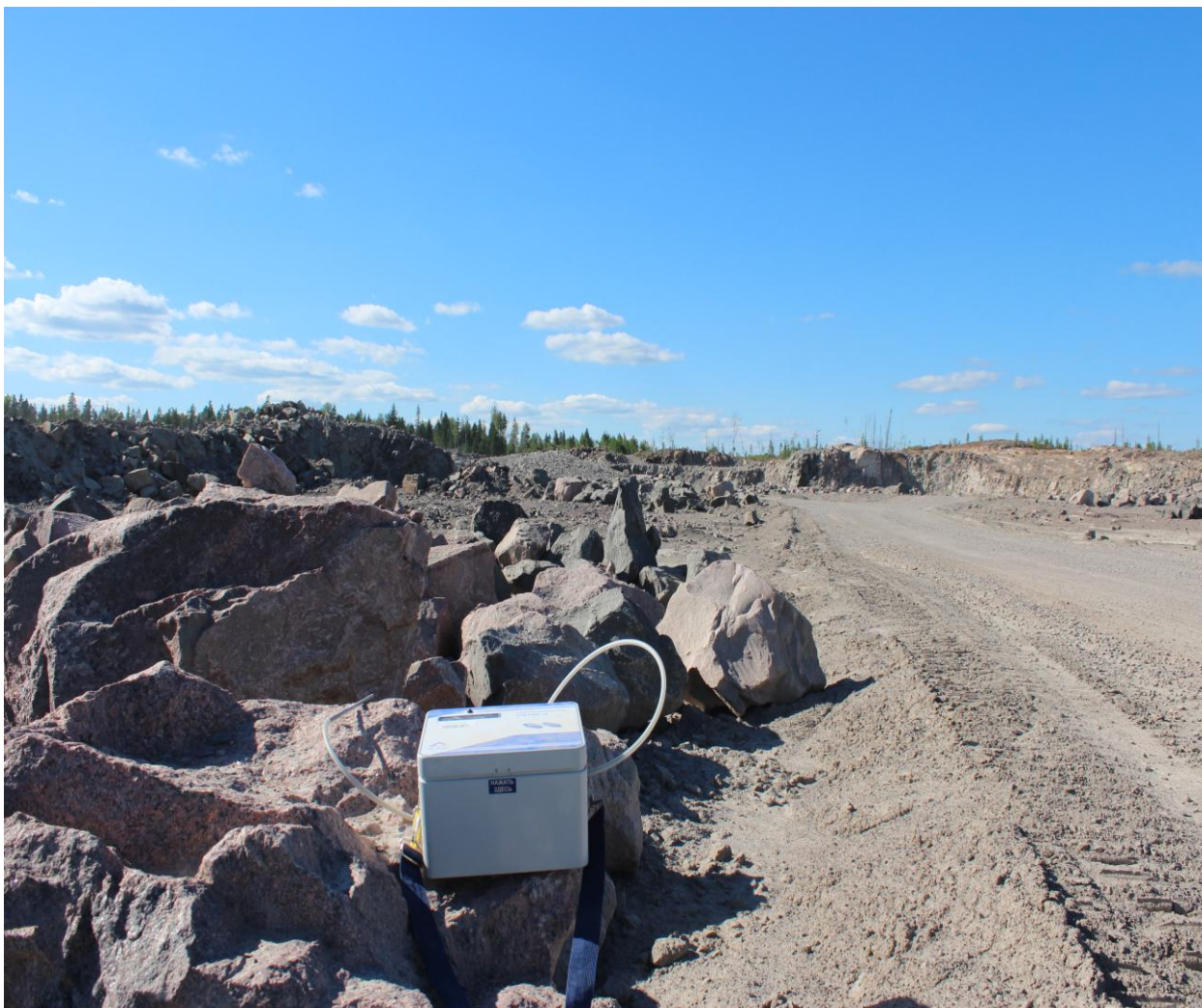
Рисунок 4.6 - Место установки газоанализатора ГАНК-4 для измерения концентрации оксидов азота
