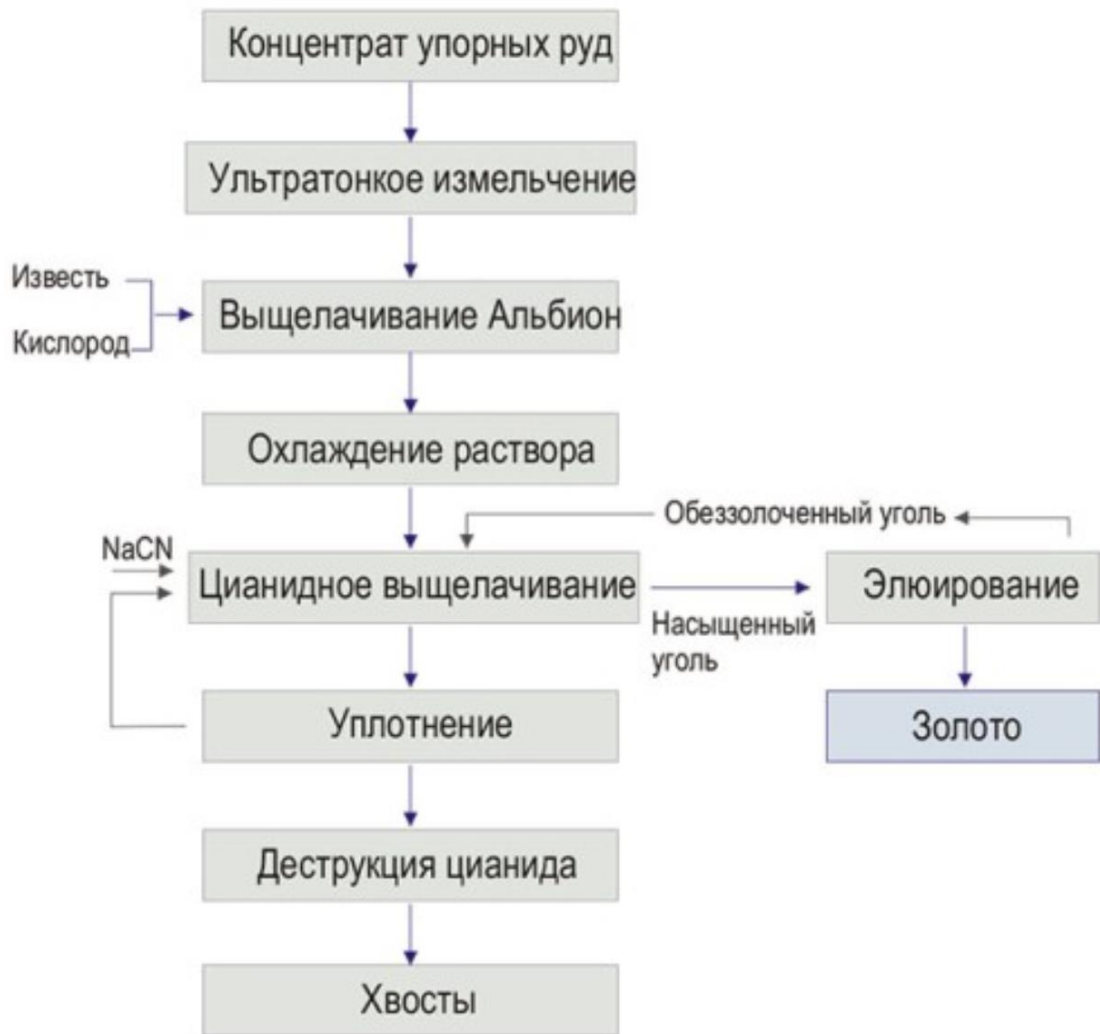
Рисунок 1.7 – Схема процесса Альбион
