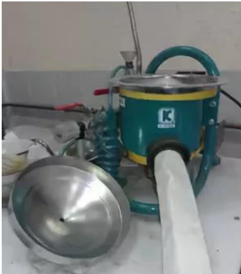
Рисунок 3.6 –Центробежный сепаратор Knelson MD3
