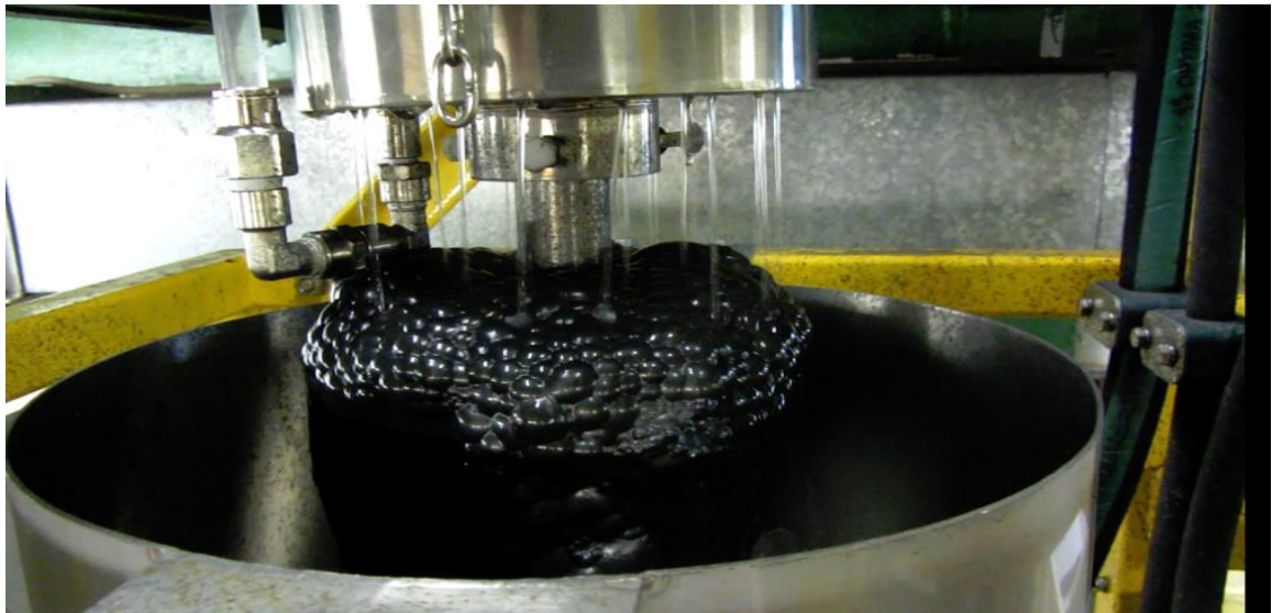
Рисунок 5.5 – Углеродная флотация на флотомашине Jameson Cell
