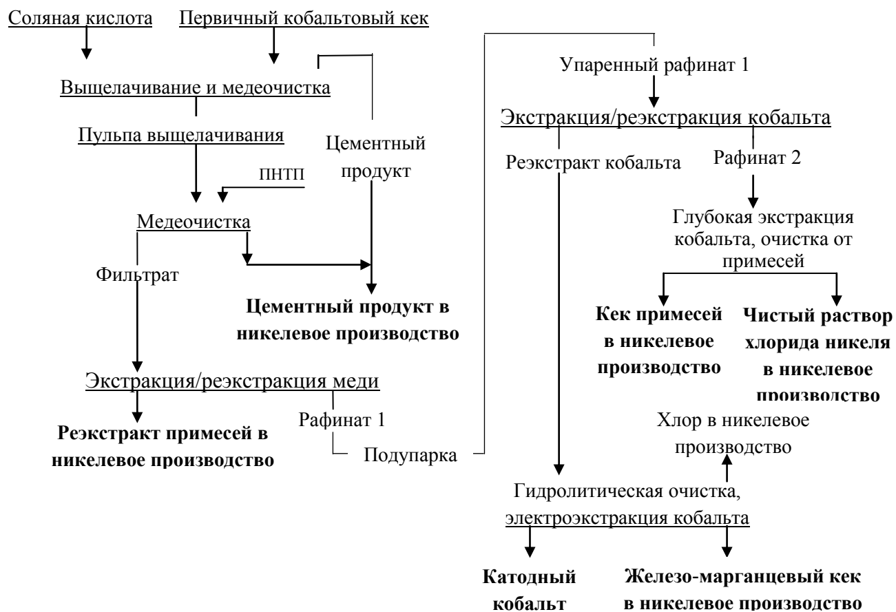
Рисунок 1.11 – Принципиальная схема хлорной технологии переработки ПНТП [110]
